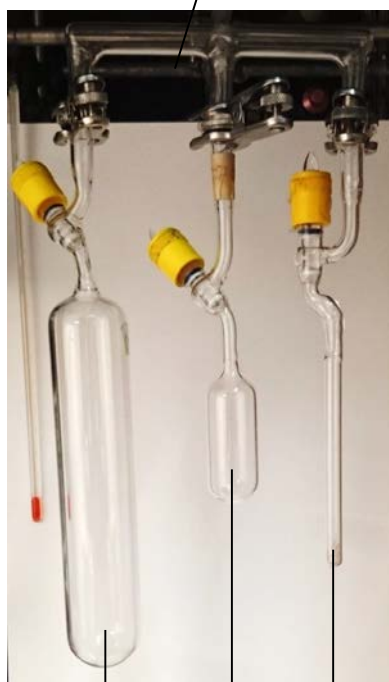
Réserve de xénon ou n-hexane Volume étalon Echantillon
