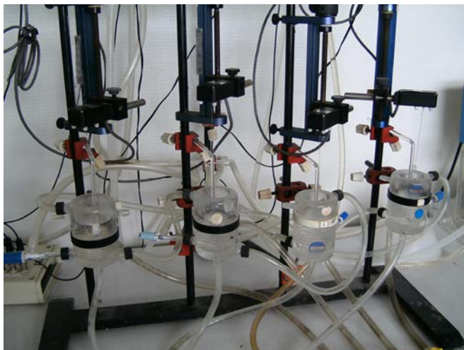
FIGURE 10 : Tensiomètre pour étude de la vasomotricité sur anneaux isolés (photographie du dessus) ; Cuves de 40 mL de solution de Krebs réchauffée à 37^{\circ}\text{C} pour incubation des anneaux (photographie du dessous)
