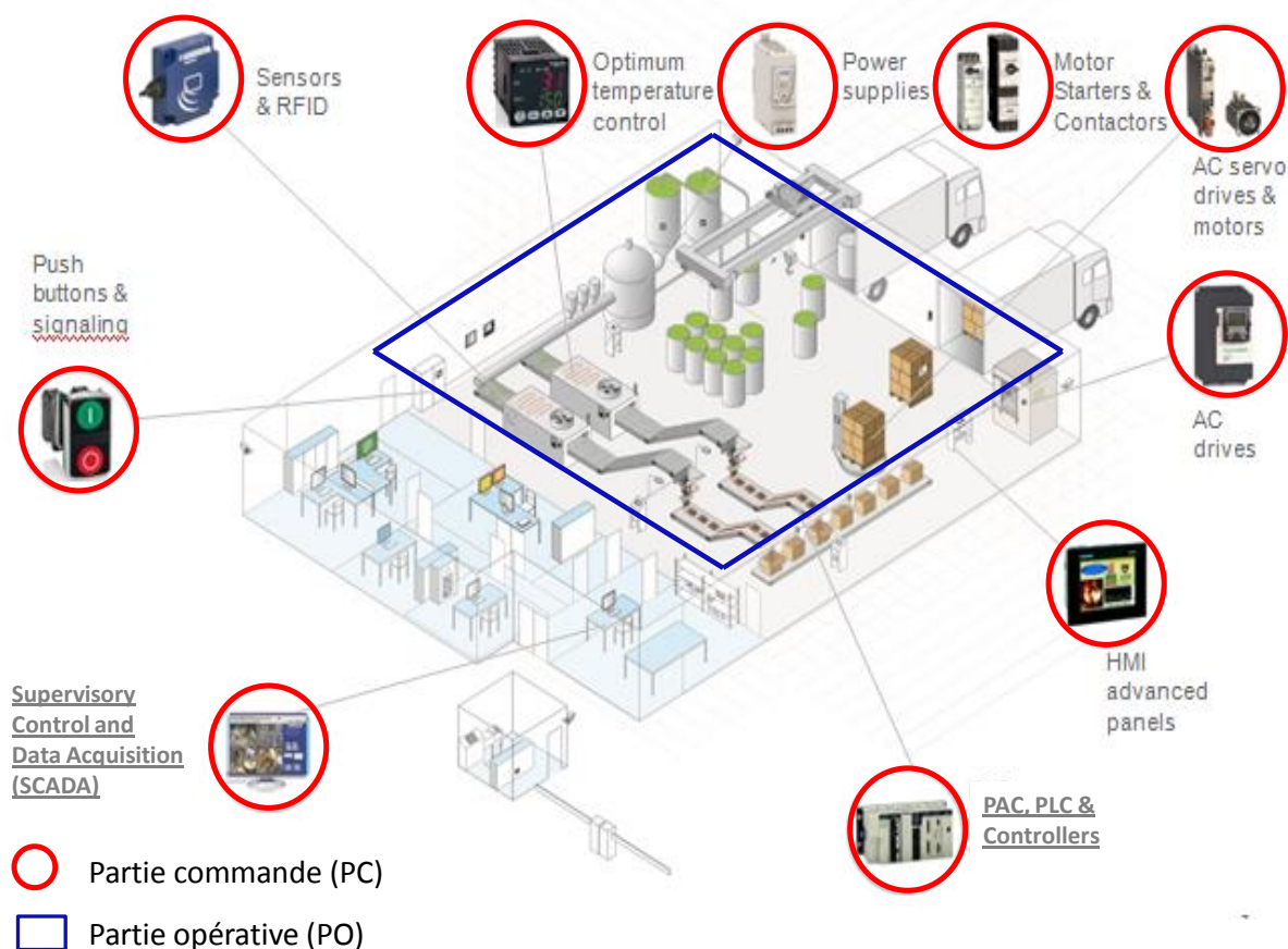
Figure II-2 : Illustrations de composants de la partie opérative (PO) et partie commande (PC) d'un système de contrôle-commande (Schneider Electric, 2008)
