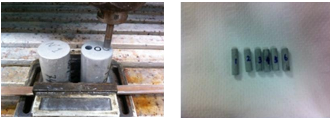
Figure 2. 8 - Obtention d'échantillons pour l'essai CT à partir de cylindres de pâte de ciment.
