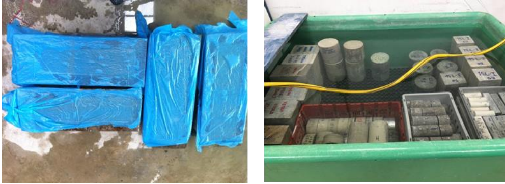
Figure 2. 1 - Conservation des poutres avant (avec les feuilles en plastique) et après (cure à l'eau 20±2°C) démoulé.
