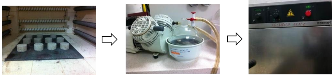
Figure 2. 7 - Préparation des rondelles pour la mesure de la porosité à l'eau ou à l'éthanol, après chauffage.
