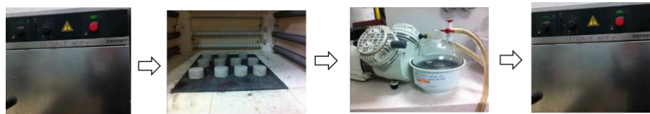
Figure 4. 1 - Processus de traitement des échantillons (cycle de chauffage/refroidissement et auto-guérison).
