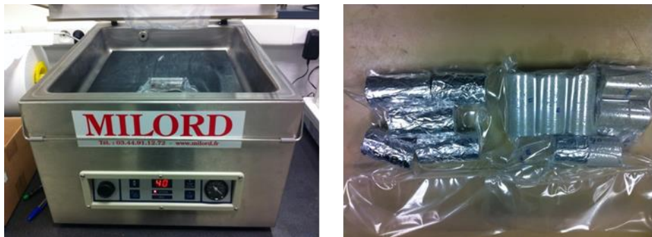
Figure 2. 3 - Dispositif de mise sous vide et de stockage des échantillons après séchage à 105 °C.
