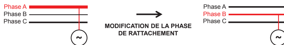
Figure 1-11 Illustration du rééquilibrage des phases BT.
