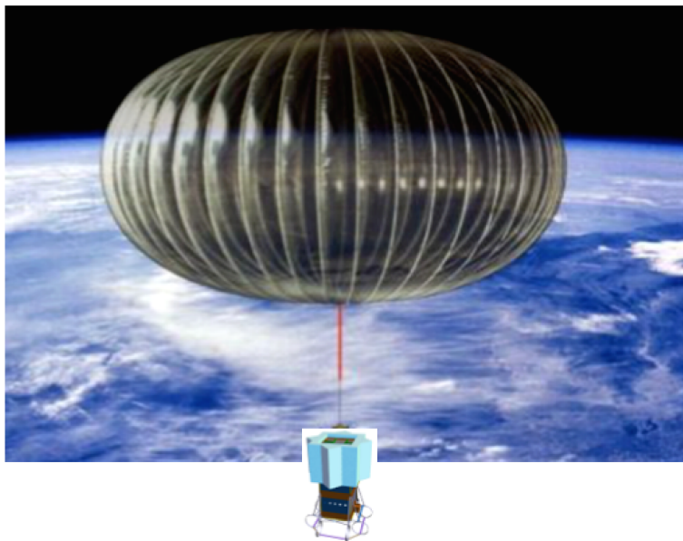
FIGURE 9.8 – Principe de EUSO-SPB : Expérience similaire à celle d'EUSO-BALLOON, avec un ballon ultra-pressurisé pour un vol longue durée de plusieurs semaines.
