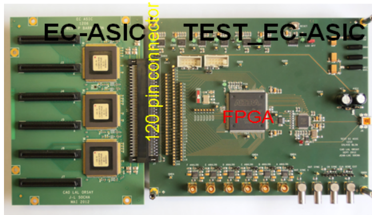
FIGURE 5.8 – Connexion d'une carte EC-ASIC et de la carte de test associée.
