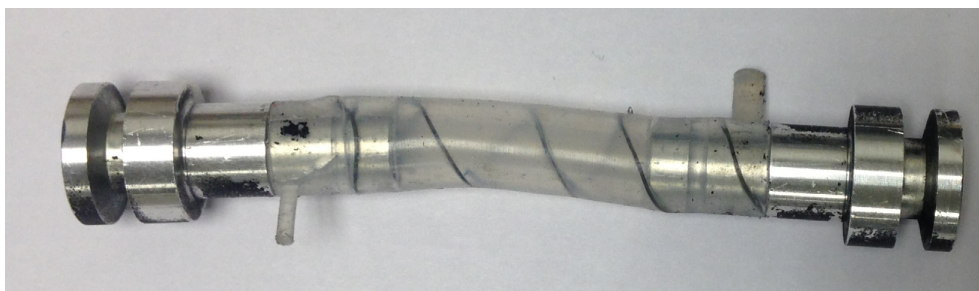
FIGURE A.4 – Coating de silicone biocompatible obtenu au moyen du dispositif développé par Rey et al. [Rey et al., 2014a].
