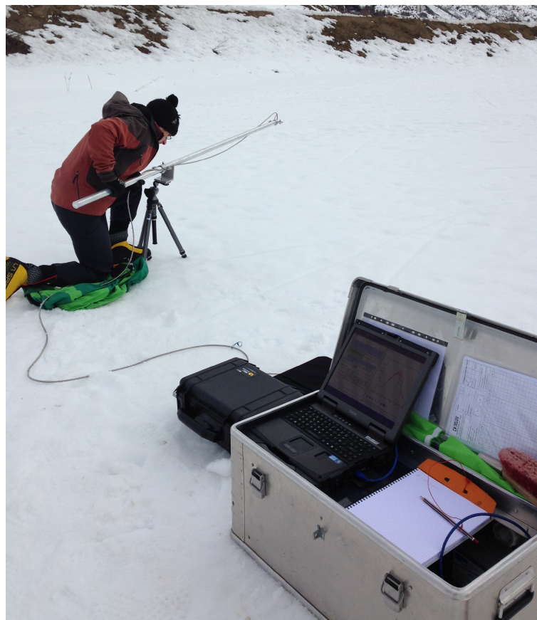
Figure 5.1: SolAlb: Instrument de mesure de réflectances spectrales. Le système est constitué d'un spectroradiomètre contrôlé par un ordinateur. Le dispositif d'acquisition est relié à un collecteur cosinus par une fibre optique. Un trépied supporte le mât où se situe à son extrémité la tête de mesure. C'est à l'utilisateur de s'assurer de l'horizontalité. Ici Pierre Spandre effectuant une mesure "ras le sol" pour étudier l'influence du positionnement du système de mesure sur les valeurs des réflectances. Col du Lautaret, le 3 décembre 2014.
