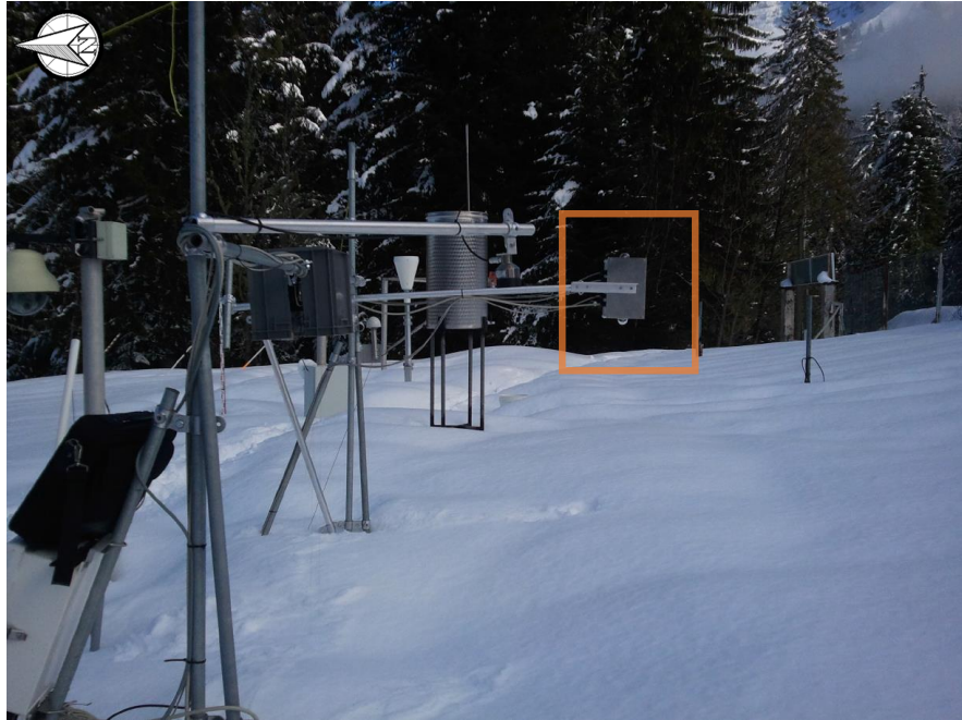
Figure 5.13: Photo de l'instrument Autosolexs installé au CdP. La tête de mesure est indiquée à l'aide du rectangle orange.
