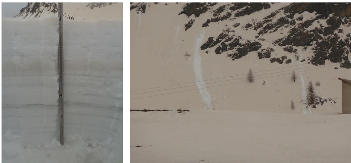
Figure 2.1: Exemples de manteaux neigeux contaminés par des impuretés. A gauche: La stratigraphie révèle une couche de neige de couleur rougeâtre. Les chutes de neiges ont par la suite recouvert cette couche. Les impuretés se concentreront en surface lorsque la neige se mettra à fondre. A droite: Dépôt en surface d'une grande quantité de poussière. Les coulées de neige laissent apparaître la neige blanche juste en dessous. Col du Lautaret, 31 mars 2016. Source : Pascal Hagenmuller.
