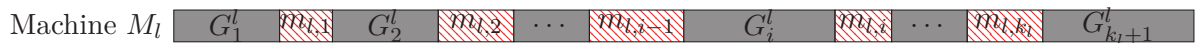
Figure 3.4 – Répartition des tâches sur la machine M_l avec k_l périodes de maintenance
