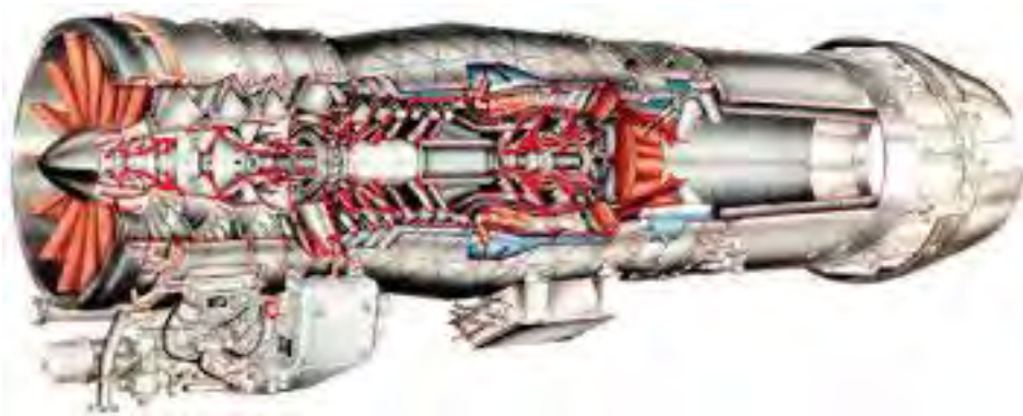
Figure 1 : Schéma du moteur M88 de Snecma [1]
