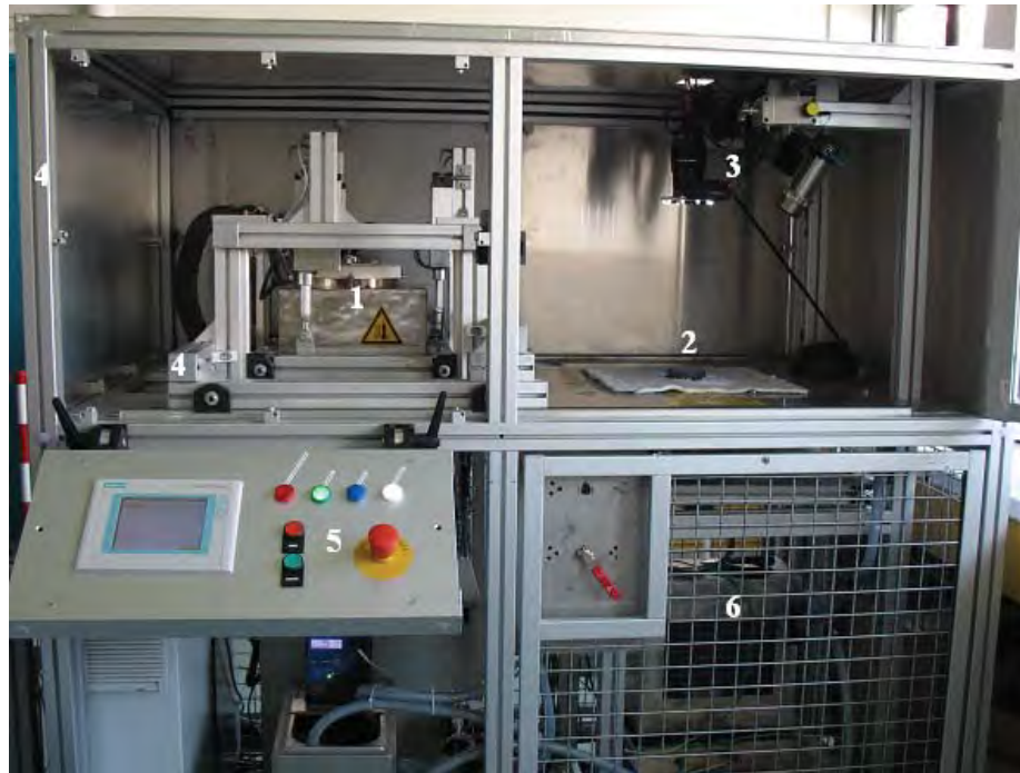
Figure 41 : Banc d'oxydation cyclique (EVE) [53]
