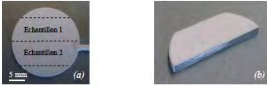
Figure 89 : Echantillons EB-PVD utilisés pour les tests d'indentation interfaciale [83]
