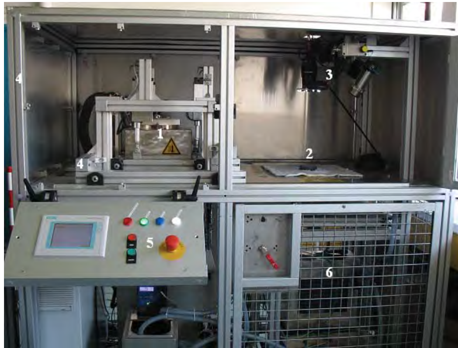
Figure 41 : Banc d'oxydation cyclique (EVE) [53]
