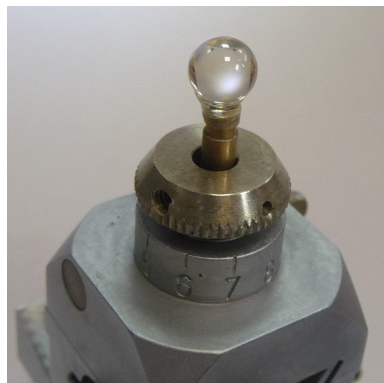
FIGURE 3.7 – Photographie de la sphère de LGT de 4,7 mm de diamètre préparée au laboratoire.
