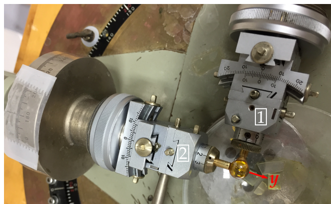
FIGURE 2.9 – Photographie de la sphère de BGSe en phase de transfert de la tête goniométrique (1) vers la tête (2).
