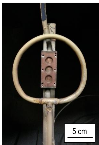
Figure IV. 8 : Anneau d'injection de l'azote
