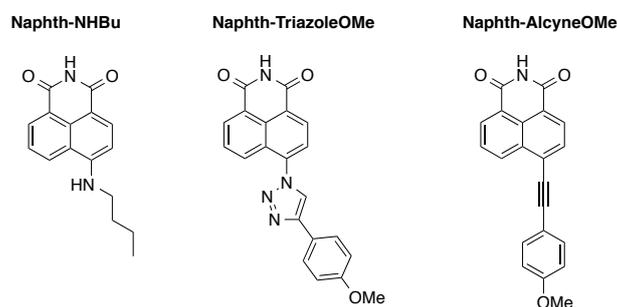
Figure 2- 14 : Structures des dérivés de naphthalimide synthétisés
