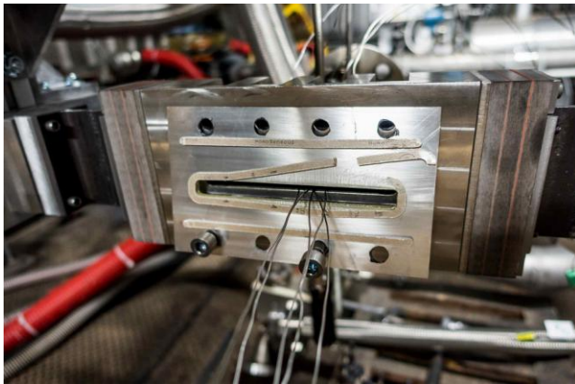
Figure 74 – Joint situé en sortie de module ayant cédé lors de la montée en température
