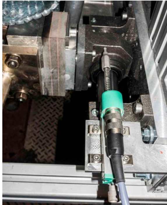
Figure 90 – Mise en place du capteur de déformation longitudinal
