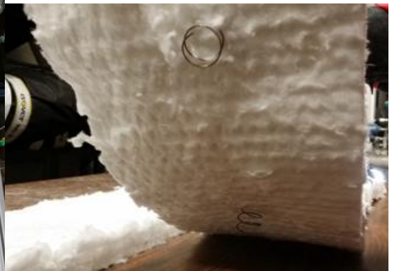
Figure 88 – Thermocouples vissés dans l'isolant et pliés pour maintenir le contact thermocouple-module
