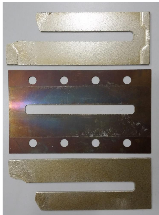
Figure 75 – Joint d'entrée et joint de sortie utilisés lors d'essais solaires après fuite d'air
