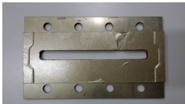
Figure 75 – Joint d'entrée et joint de sortie utilisés lors d'essais solaires après fuite d'air
