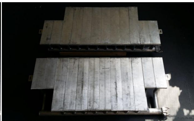
Figure 77 – Panneaux réfrigérés avant peinture – Vue face avant
