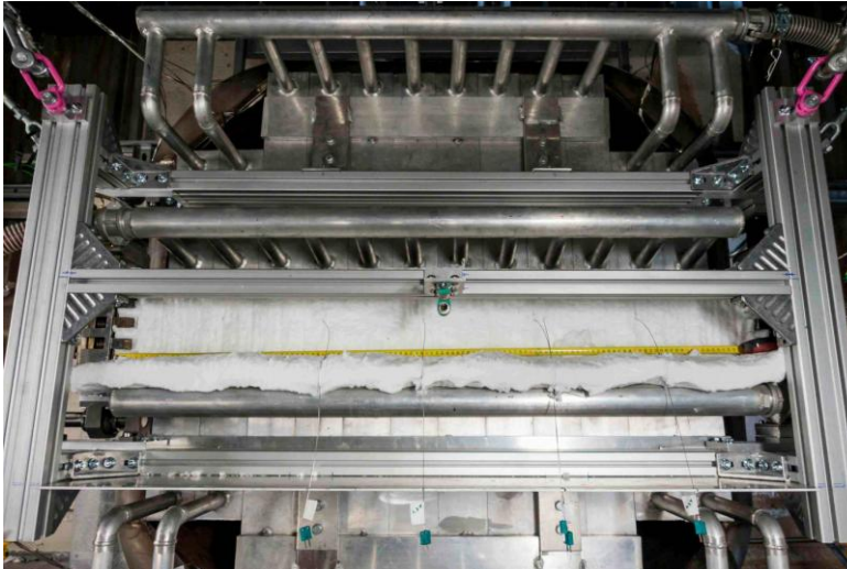
Figure 87 – Mise en place des thermocouples en face arrière et de l'isolation du module
