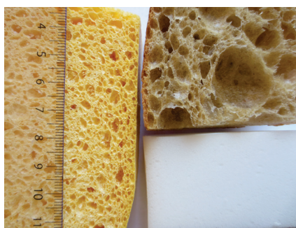
Figure 1.8 – Photographie de matériaux à porosité variable : éponge cellulose (jaune), éponge en mélamine (blanche) et du pain. En majorité, les pores sont interconnectés.
