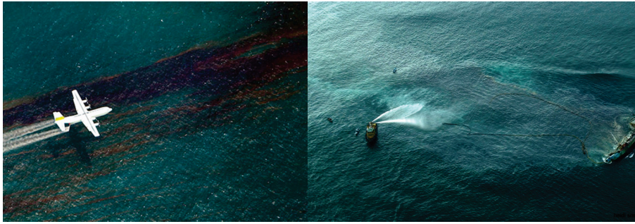
Figure 1.2 – Photographies d’applications de dispersants chimiques sur une nappe de pétrole [102].
