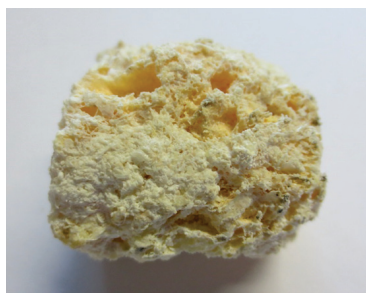
Figure 3.23 – Photographie d'éponge en cellulose greffée de polystyrène après l'essai n°2. Le greffage du polystyrène est plus régulier que lors du premier essai, mais certaines zones restent peu recouvertes.
