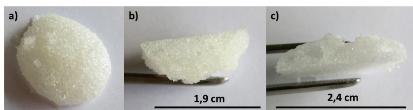
Figure 4.1 – Photographies d'éponges en PDMS obtenues par mélange de sucre en poudre et de la solution polymère après réticulation de six heures (a et b) ou douze minutes (c). Après lavage à l'eau, les faces internes (b et c) ont une macroporosité différente. L'éponge réticulée six heures reste rigide et ferme, alors que celle réticulée douze minutes est plus poreuse et plutôt souple, ce qui pourrait s'expliquer par une meilleure élimination du sucre au cours de l'étape de lavage.
