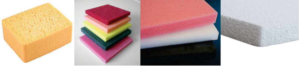
Figure 1.6 – Photographies d’éponge artificielle en cellulose, et éponges synthétiques en polyuréthane, polyéthylène et polystyrène (de gauche à droite).
