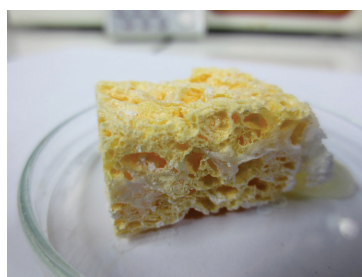
Figure 3.22 – Photographie d'éponge en cellulose greffée de polystyrène après l'essai n°1. Le greffage est inhomogène.
