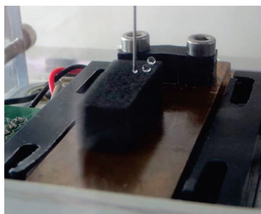
Figure 5.20 – Photographie de gouttes d'eau déposées sur l'échantillon à 500 °C : les gouttes restent à la surface de l'éponge et ne sont pas absorbées.
