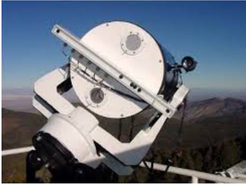
FIGURE 4.1 – L’instrument comprenant un télescope de 35 cm de diamètre utilisé comme S-DIMM avec deux ouvertures de 5 cm séparées par une distance de 23 cm. La barette de scintillomètres (SHABAR) d’une longueur de 55 cm est visible sur la pupille d’entrée.
