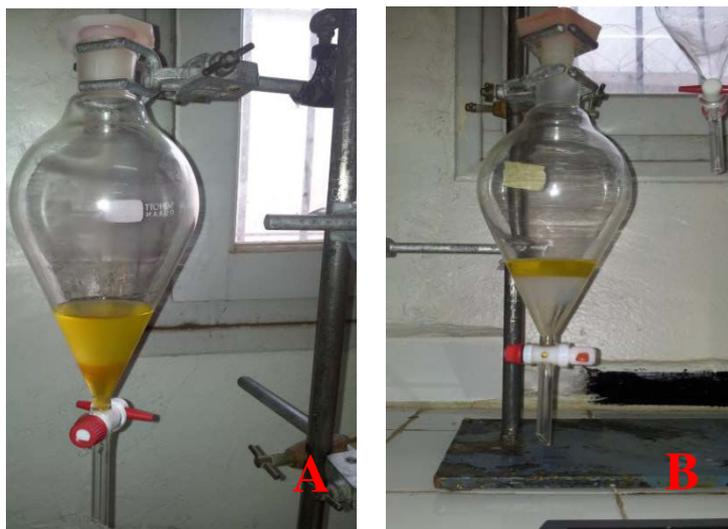
**Figure II.7:** Formation des deux phases : A (avant lavage : esters alkyliques/glycérine) ; B (après lavage : biodiesel/eau)
