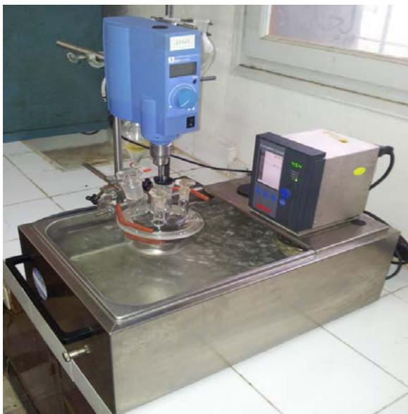
**Figure II.6:** Montage expérimental de la réaction de transestérification
