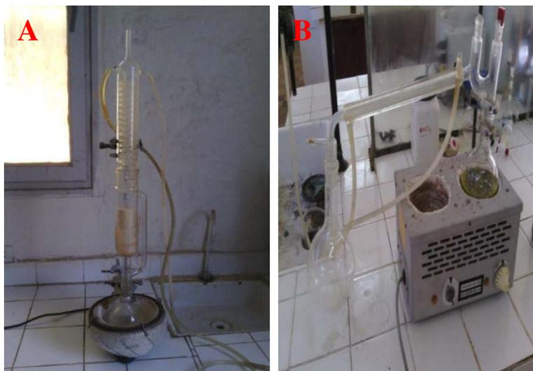
**Figure II.5:** Montages d'extraction Soxhlet [A] et de distillation [B]
