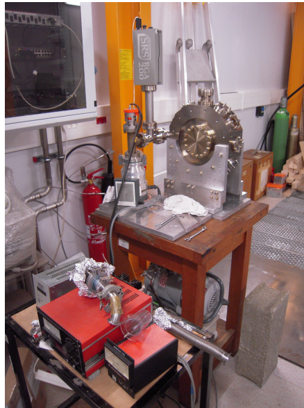
Fig. II.1 Premiers pompages sur l'enceinte à vide en court d'assemblage.
