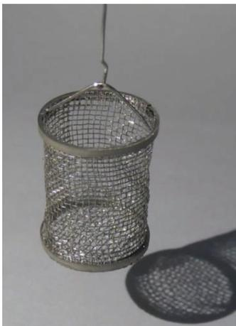
**Figure 5-3 :** Photographie de la nacelle grillagée en platine iridié utilisée pour les traitements thermiques en présence de vapeur d'eau
