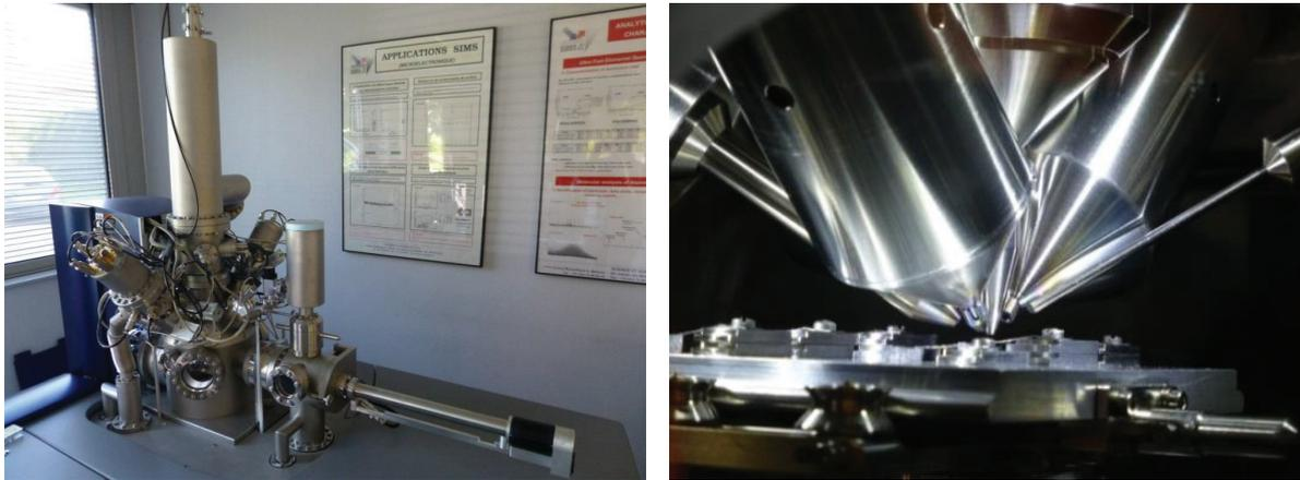
*Figure 3-8 : Photographies du spectromètre IONTOF ToF-SIMS V et de la chambre d'ionisation*
