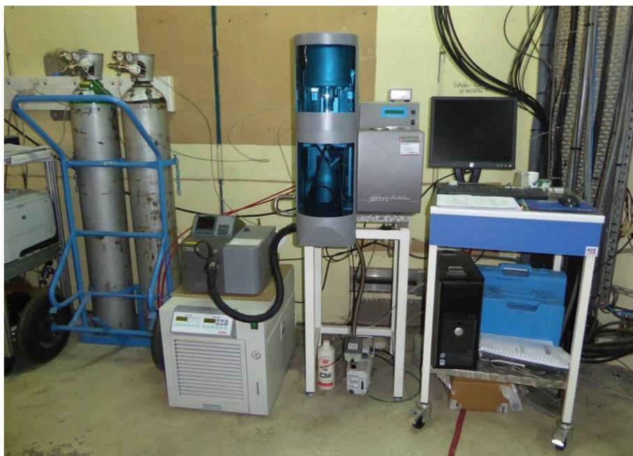
**Figure 5-1 :** Photographie du dispositif expérimental utilisé pour les traitements thermiques en présence de vapeur d'eau
