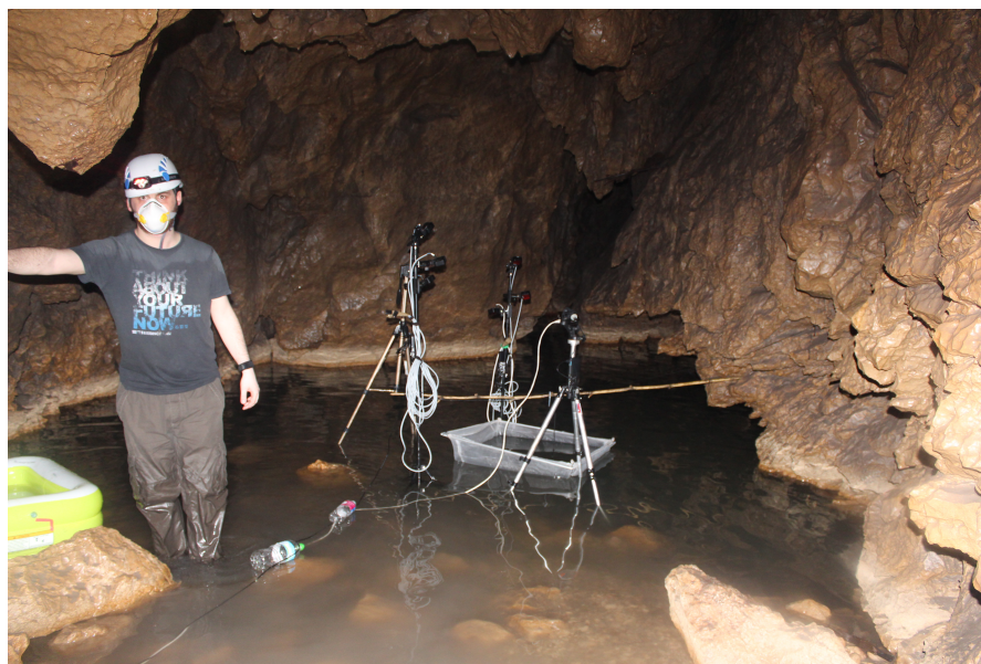
Figure 50. Mise en place du dispositif expérimental d'enregistrement vidéo et audio longue durée dans la grotte Rio Subterraneo.
