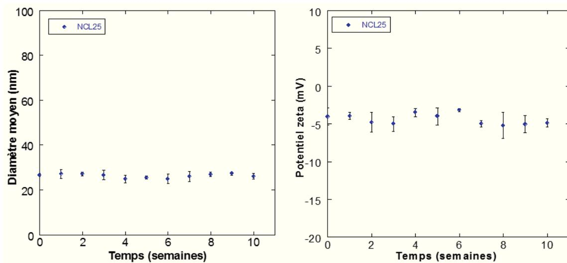
**Figure 1.13** - Evolution de la taille et du potentiel zêta des NCL25 au cours du temps.
