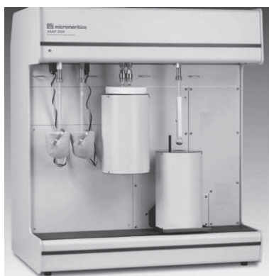
Figura II.8: Instalația BET utilizată pentru efectuarea măsurătorilor de adsorbție-desorbție de gaz.
