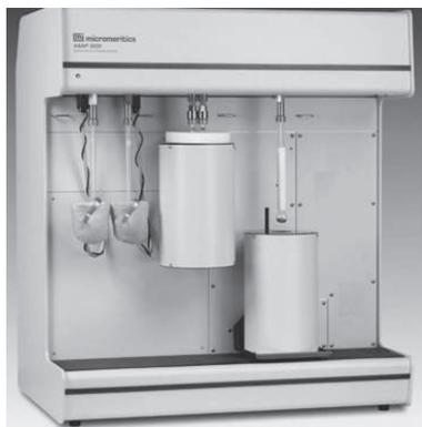
**Figura II.8:** Instalația BET utilizată pentru efectuarea măsurătorilor de adsorbție-desorbție de gaz.
