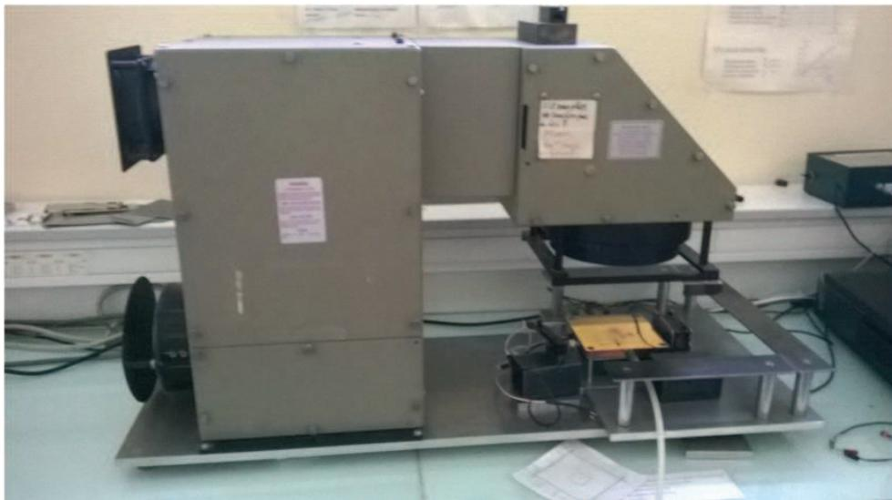
Figure II-11: image du simulateur solaire de la marque Oriel utilisé pour le test de nos cellules
