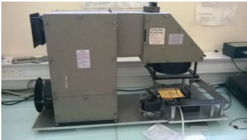
Figure II-11: image du simulateur solaire de la marque Oriel utilisé pour le test de nos cellules
