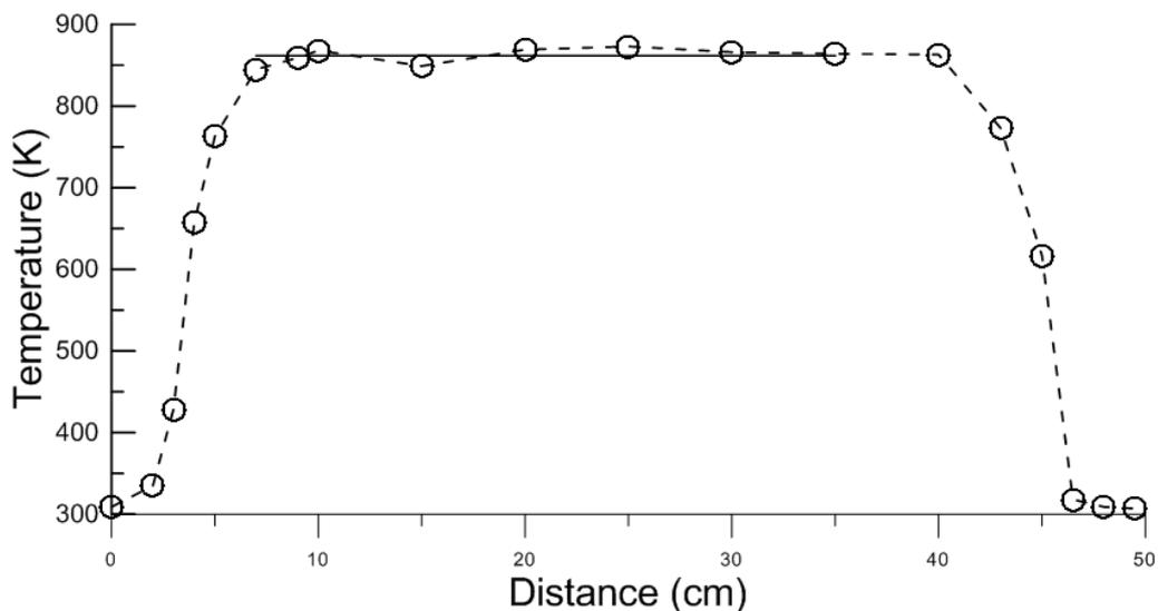
Figure II- 3 : Profil de température entre 0 et 50 cm par rapport à la fin du réacteur avec une température de consigne de 862 K et une pression de 1 Torr.
