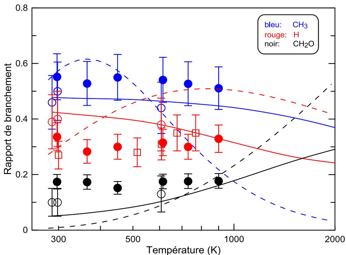
Figure V- 13 : Rapports de branchement pour CH<sub>3</sub>, H et CH<sub>2</sub>O en fonction de la température. Etudes théoriques : lignes continues Nguyen *et al.*<sup>88</sup> et lignes pointillées Li *et al.*<sup>89</sup>. Etudes expérimentales : cercles pleins notre étude ; cercles vides Peeters & Maes<sup>82</sup> et carrés vides Smalley *et al.*<sup>80</sup>.
