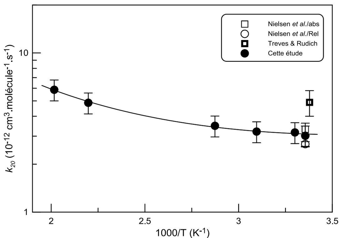
Figure IV- 20 : Ensemble des mesures pour la constante de vitesse du 1-PTNT + OH. Les données proviennent de :  $\square$  Nielsen et al.<sup>65</sup> méthode absolue,  $\circ$  Nielsen et al.<sup>65</sup> méthode relative,  $\blacksquare$  Treves & Rudich<sup>71</sup>.
