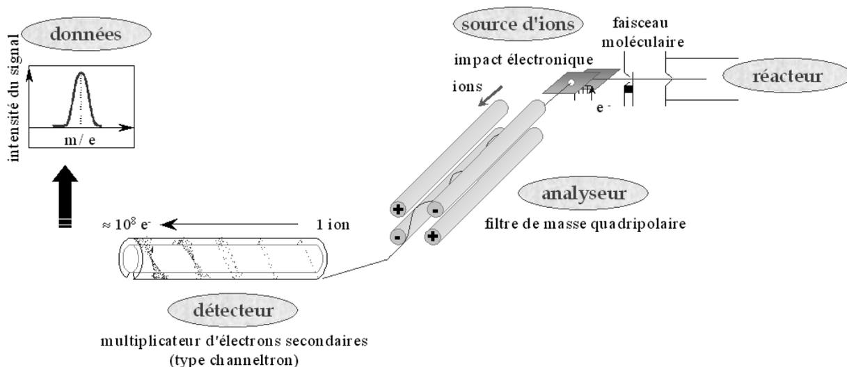
Figure II- 9 : Schéma de principe d'un spectromètre de masse avec quadripôle<sup>36</sup>.
