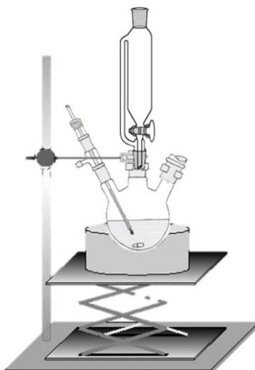
Figure II- 5 : Montage expérimental utilisé pour la synthèse des différents nitrates d'alkyles.
