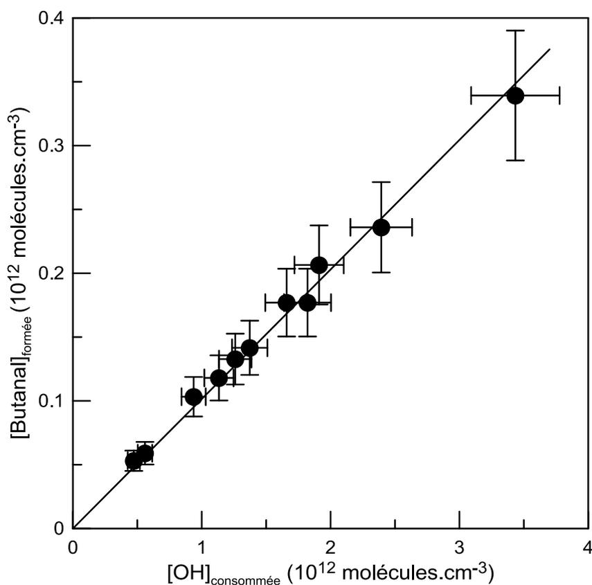
Figure IV- 15 : Concentration du butanal formé en fonction de la concentration de OH consommé à 300 K. Les barres d'erreurs correspondent à une incertitude de  $\pm 15\%$  sur les concentrations des composés. Cette incertitude est prise en compte pour le fit.
