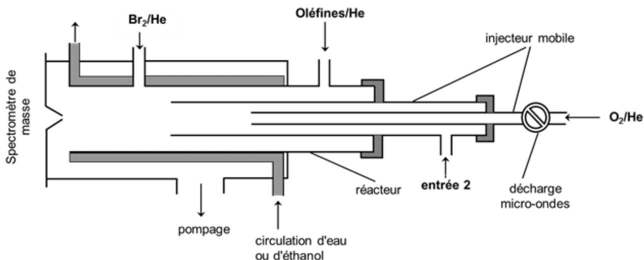
Figure V- 2 : Dispositif expérimental pour les réactions oléfines + O(<sup>3</sup>P) pour les températures entre 230 et 350 K.
