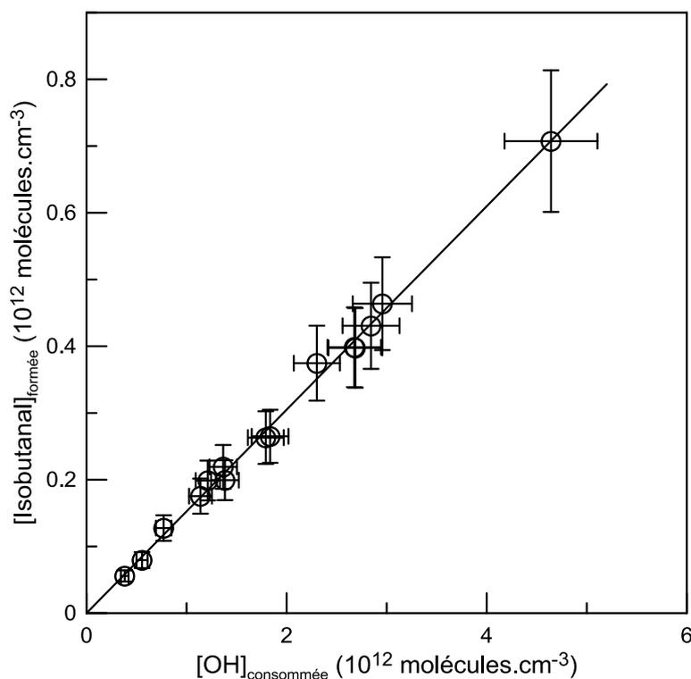
Figure IV- 17: Concentration de l'isobutanol formé en fonction de la concentration de OH consommé à 300 K. Les barres d'erreurs correspondent à une incertitude de  $\pm 15\%$  sur les concentrations des composés. Cette incertitude est prise en compte pour le fit.
