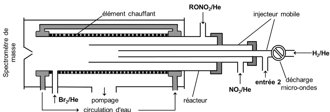
Figure IV- 2 : Dispositif expérimental pour les réactions nitrates + OH dans le domaine de température 300-538 K.
