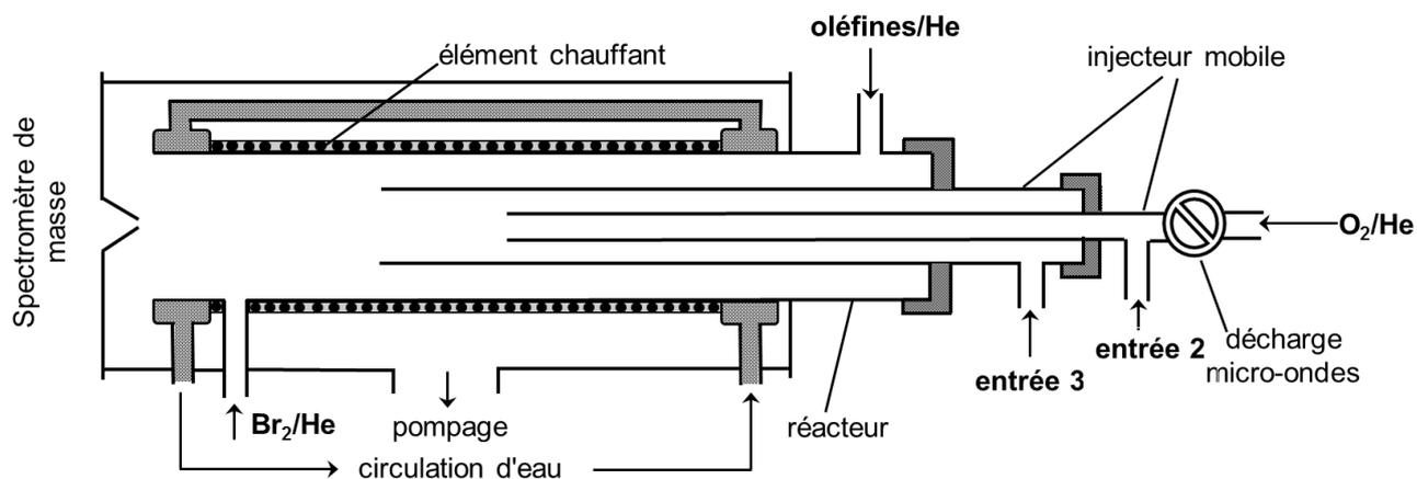
Figure V- 3 : Dispositif expérimental pour les réactions oléfines+ O(<sup>3</sup>P) pour les températures entre 298 à 902 K.
