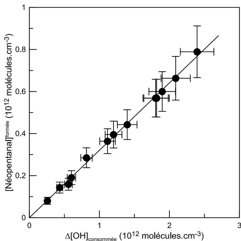
Figure IV- 19 : Concentration du néopentanal formé en fonction de la concentration de OH consommé à 300 K. Les barres d'erreurs correspondent à une incertitude de  $\pm 15\%$  sur les concentrations des composés. Cette incertitude est prise en compte pour le fit.
