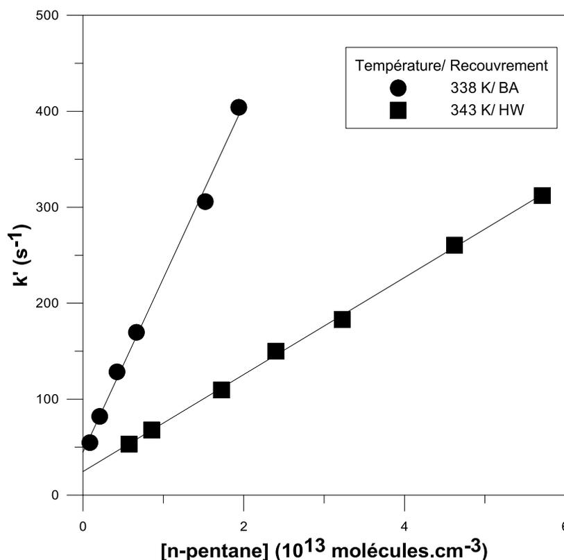
Figure III- 8 : Réaction  $\text{OH} + \text{C}_5\text{H}_{12}$  : exemple de constante de vitesse pour deux types de réacteurs, un en pyrex recouvert de cire halogénée (HW) et l'autre en quartz recouvert d'acide borique (BA).
