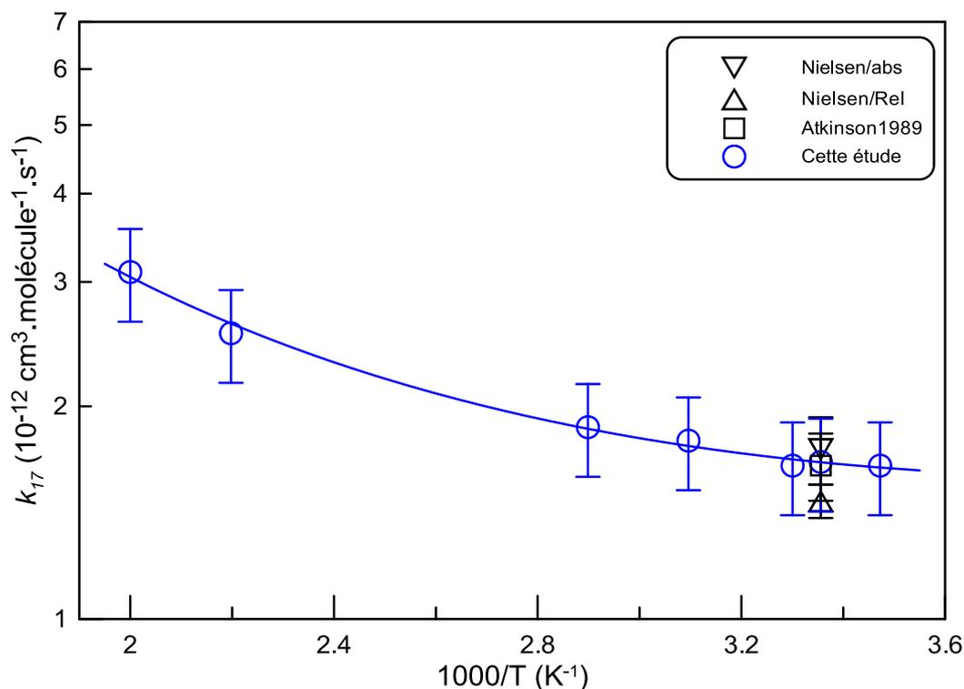
Figure IV- 14 : Ensemble des mesures pour la constante de vitesse 1-BNT + OH. Les données proviennent de :  $\nabla$  Nielsen et al.<sup>65</sup> méthode absolue,  $\triangle$  Nielsen et al.<sup>65</sup> méthode relative,  $\square$  Atkinson & Aschmann<sup>59</sup>.
