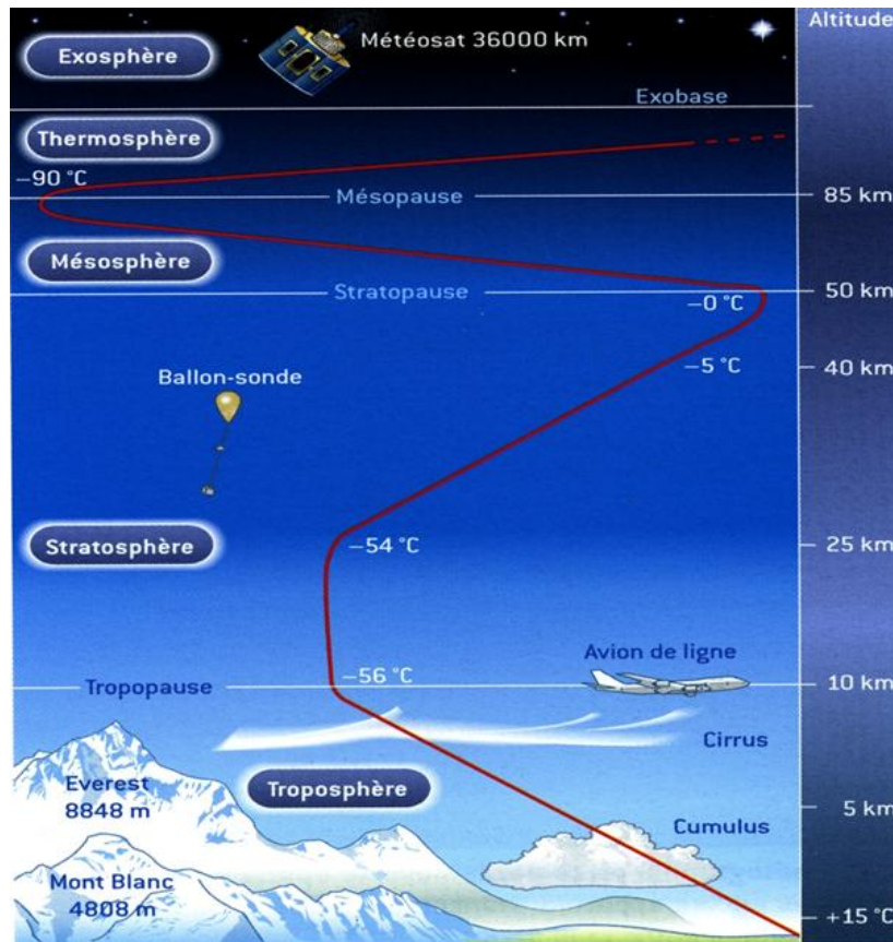
Figure I- 1: Les différentes couches atmosphériques avec la variation de la température en fonction de l'altitude (courbe rouge) 1 .
