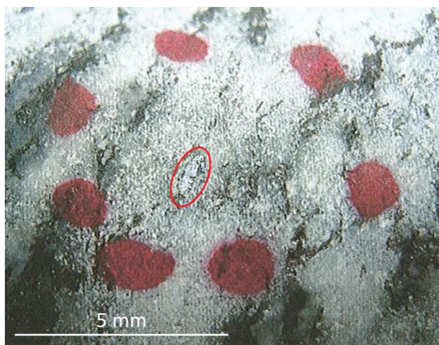
Figure II-2 : Echantillon de granodiorite de Sunderbyn (région de Luleå, Suède) présentant quelques grains de molybdénite <1 mm (ici entouré en rouge) demandant une extraction par broyage et séparateur magnétique Frantz.
