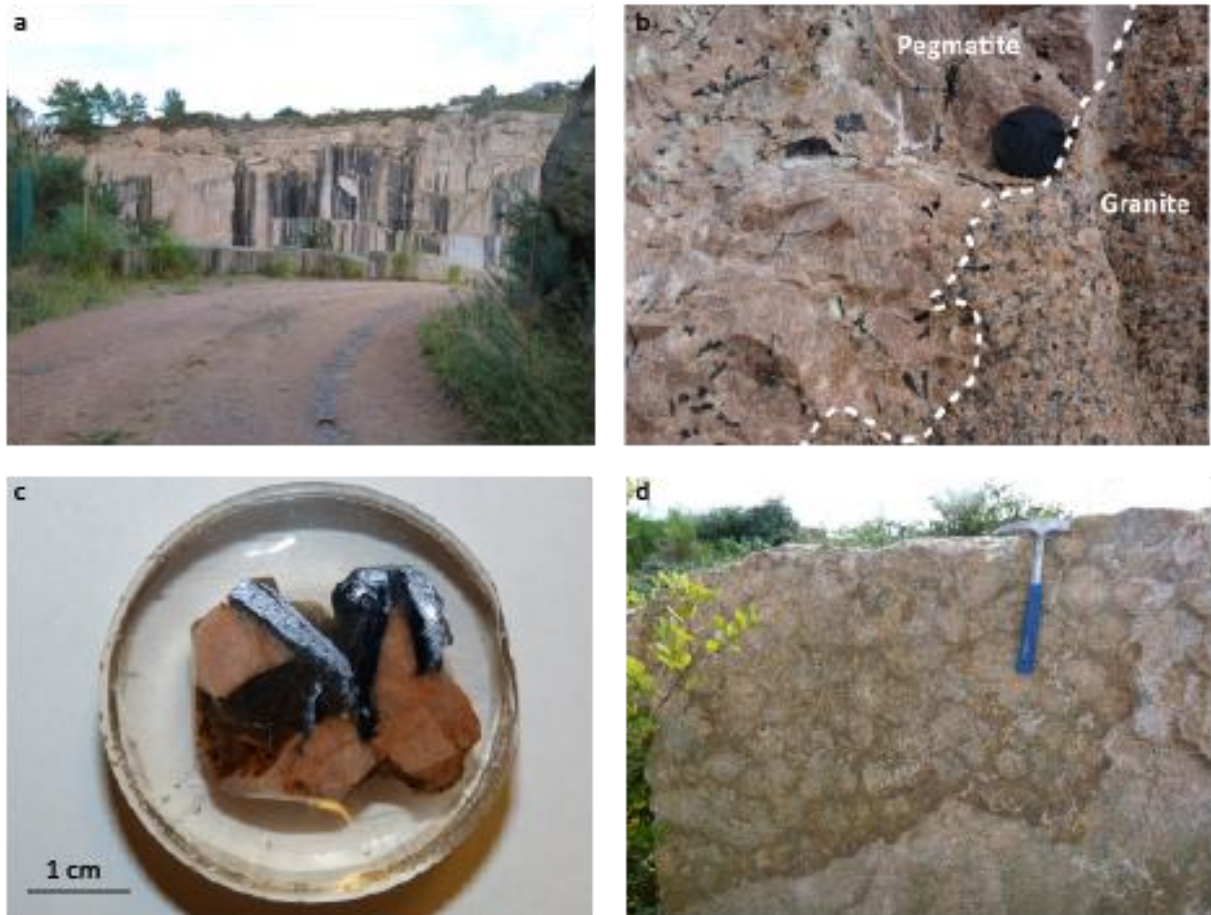
Figure V-9 : a) Carrière BGP de la Clarté-Ploumanac’h dont les rebus nous ont été rendus accessibles pour la recherche d’échantillons. b) Limite granite-pegmatite sur un bloc provenant de cette même carrière. c) Section polie de la pegmatite de Ploumanac’h où l’on aperçoit des lamelles de molybdénites allant jusqu’à 1,3 cm de longueur. d) Poche de granite orbiculaire d’un bloc provenant de la carrière BGP.
