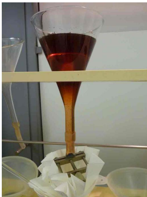
Figure II-11 : Séparation par lixiviation avec du diodométhane dense. La molybdénite étant plus dense que le diodométhane (3,3), elle se retrouve dans la partie inférieure de la colonne.
