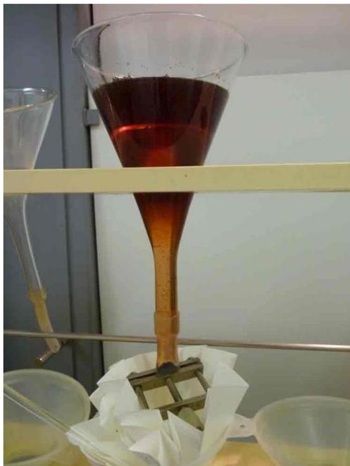
**Figure II-11 : Séparation par liqueur dense diodométhane. La molybdénite étant plus dense que le diodométhane (3,3), elle se retrouve dans la partie inférieure de la colonne.**
