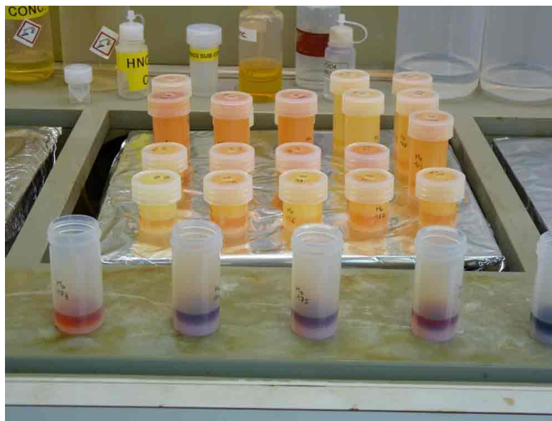
Figure II-3 : Mise en solution des molybdénites dans de l'eau régale ( \text{HNO}_3 + \text{HCl} ) et quelques gouttes d'HBr placés sur une plaque chauffante.
