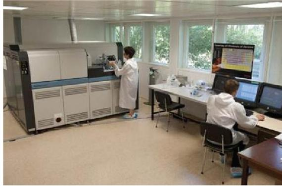
**Figure II-4 : Salle blanche du MC-ICP-MS Neptune du BRGM.**
