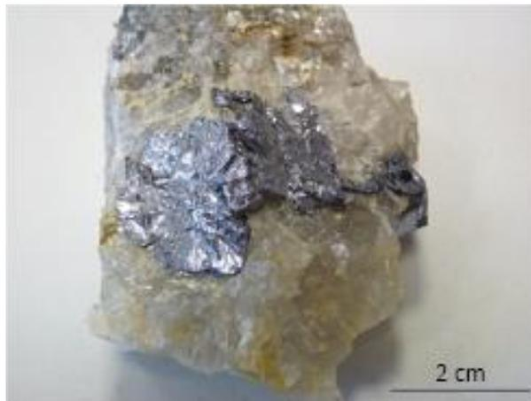
**Figure I-3 : Molybdénite de la Butte (Abitibi, Canada), ressemblant au graphite de par sa couleur : gris argenté avec un éclat métallique. Les feuillets sont très flexibles. La molybdénite cristallise dans le système hexagonal et a un clivage parfait {001}.**
