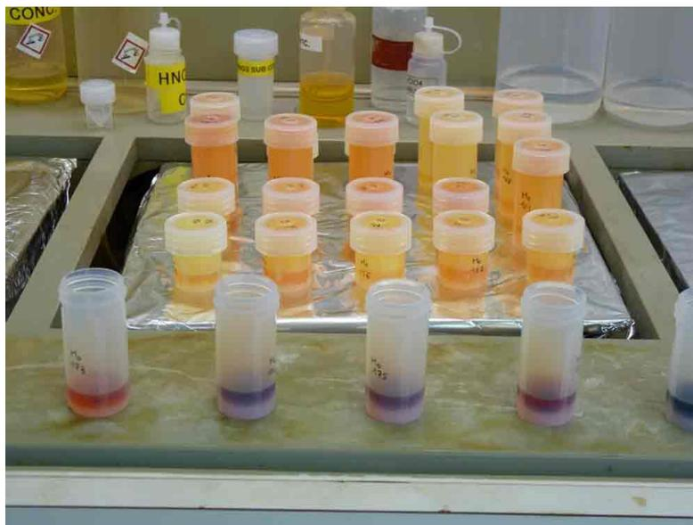
**Figure II-3 : Mise en solution des molybdénites dans de l'eau régale ( $\text{HNO}_3 + \text{HCl}$ ) et quelques gouttes d'HBr placés sur une plaque chauffante.**
