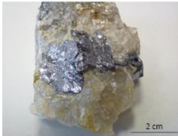
Figure I-3 : Molybdénite de la Butte (Abitibi, Canada), ressemblant au graphite de par sa couleur : gris argenté avec un éclat métallique. Les feuillets sont très flexibles. La molybdénite cristallise dans le système hexagonal et a un clivage parfait {001}.
