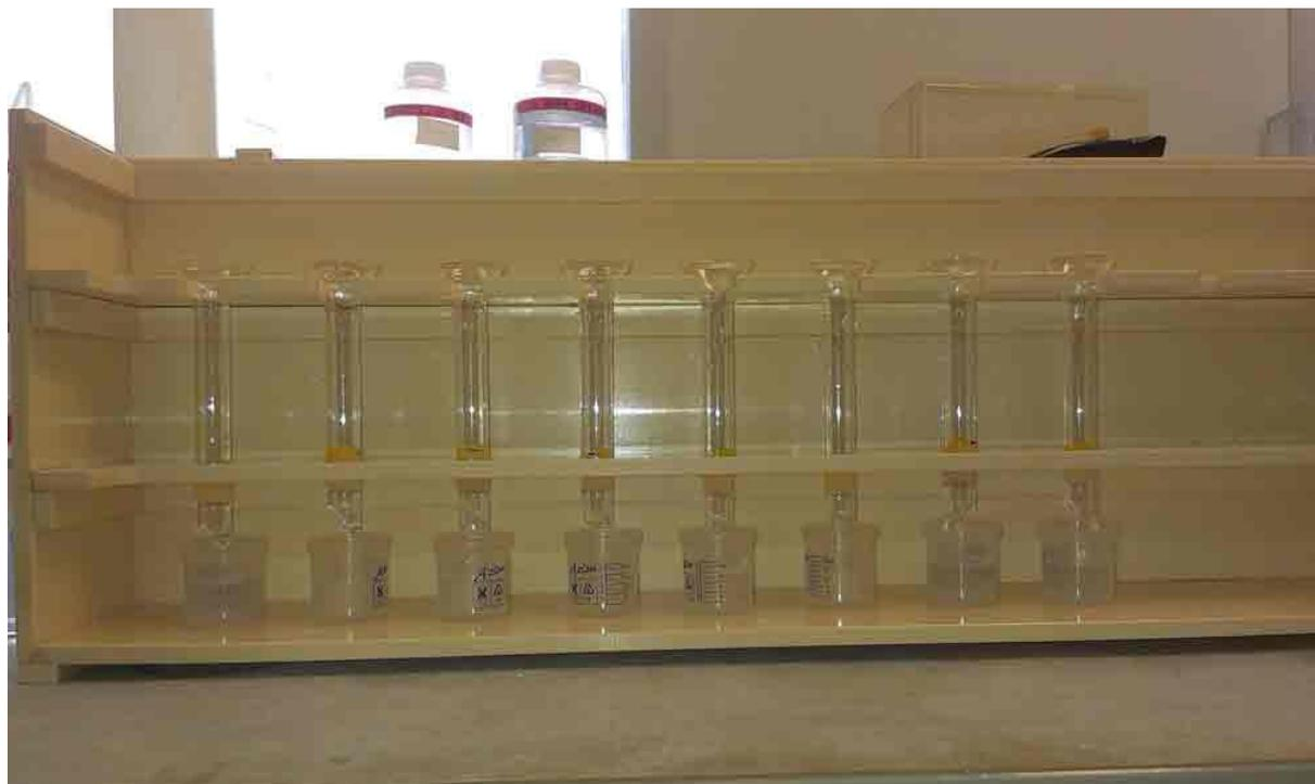
**Figure II-10 : Colonne de séparation chimique du plomb.**
