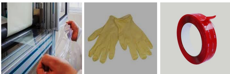
Figure 10 : Elastomères diélectriques souvent utilisés. De gauche à droite : Silicone, Latex, Acrylique
