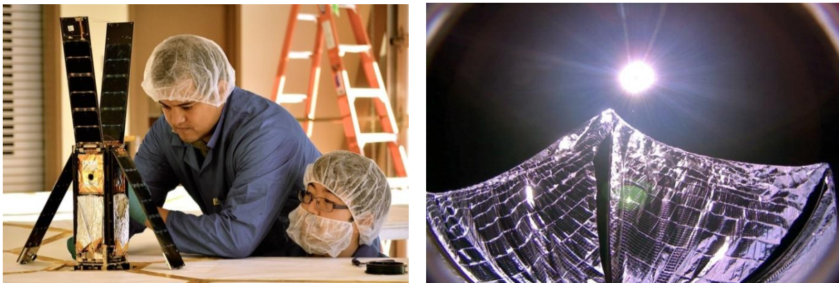
Figure 22 : Exemple d'un mini satellite utilisant des voiles solaires développé par « The Planetary Society » (projet LightSail™ 2014) à gauche : dimensions du satellite par rapport à une personne; à droite : vue des voiles déployées dans l'espace
