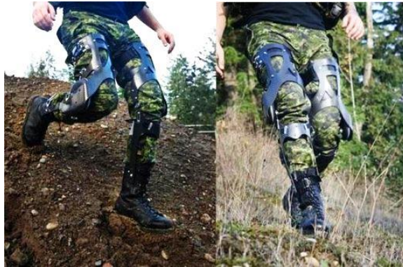
Figure 14 : Système de récupération d'énergie sur la marche (Power Walk)
