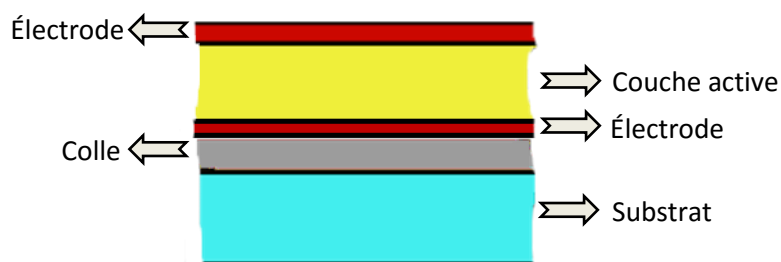
Figure 146 : Exemple de vue en coupe d'un film électroactif
