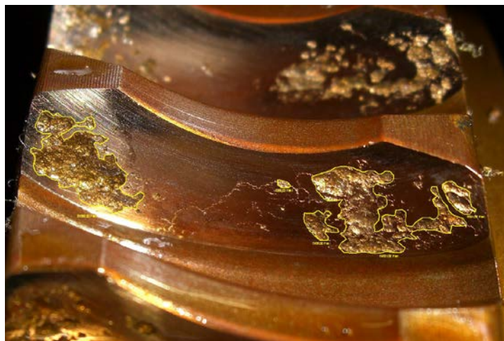
Figure I.35 : Pitting d'une roue en bronze [158]
