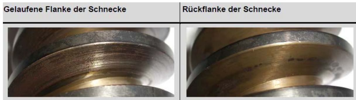
Figure I.51 : Les filets de la vis après la fin de l'essai [158]
