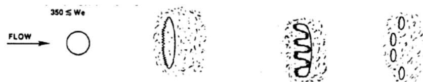
Figure 81 : Mécanisme de brisure d'une goutte pour différents nombres de Weber [130]
