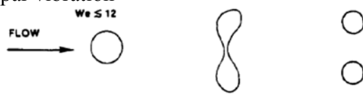
(a) Brisure par vibration
