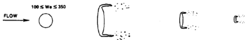
(e) Arrachement de crêtes ondulées suivi d'une brisure totale
