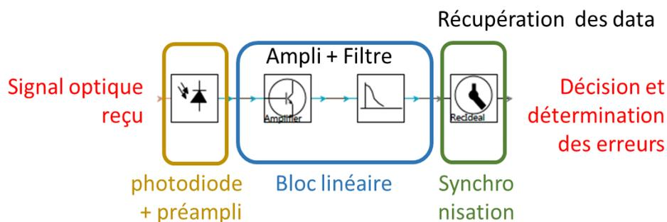
Figure II- 6 : Synoptique du module de réception
