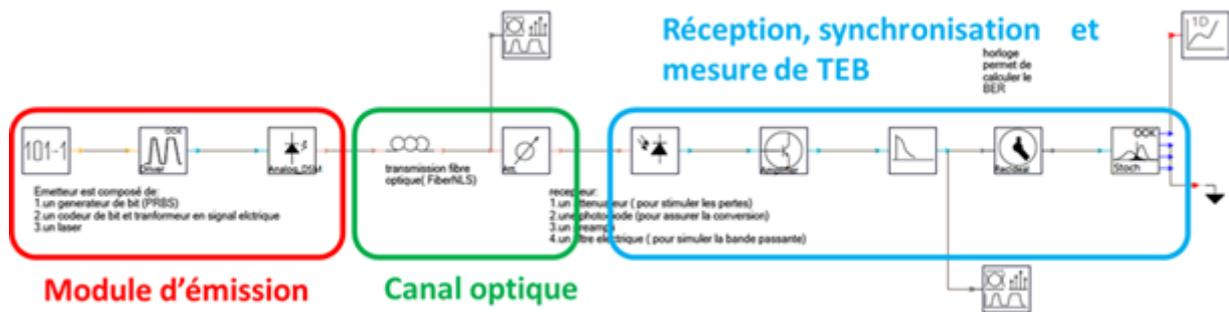
Figure II- 1 : Structure générale d'une liaison optique
