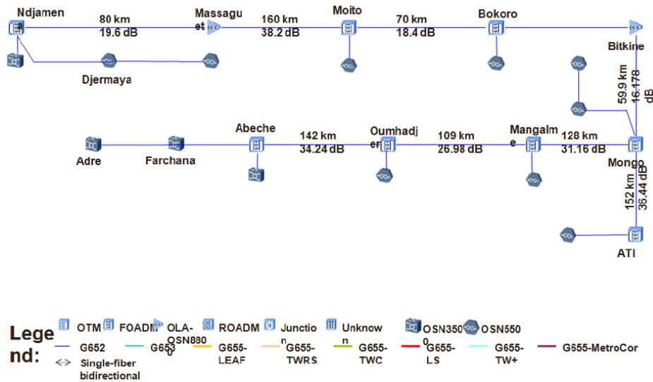
Figure V- 4 : Topologie du réseau Tchad en déploiement
