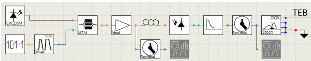
Figure II- 10 : Schéma synoptique d'une liaison optique à modulation externe à base de MZM
