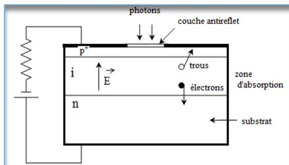
Figure II- 7 : Schématique simple d'une photodiode PIN [14]
