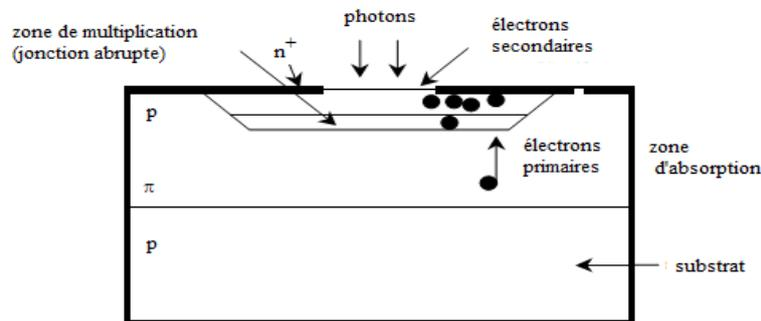
Figure II- 8 : Schématique simple d'une photodiode APD [14]
