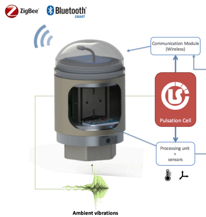
Figure 56 Projet de système de surveillance autonome en énergie pour la maintenance préventive de machines tournantes
