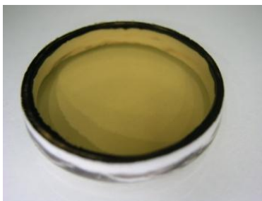
Figure.17.Photo de l'Upilex® collé sur la bague en macor.
