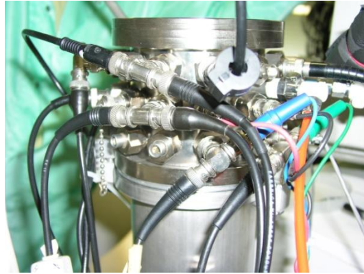
Figure.51. Branchements des câbles BNC sur les connecteurs du calorimètre.
