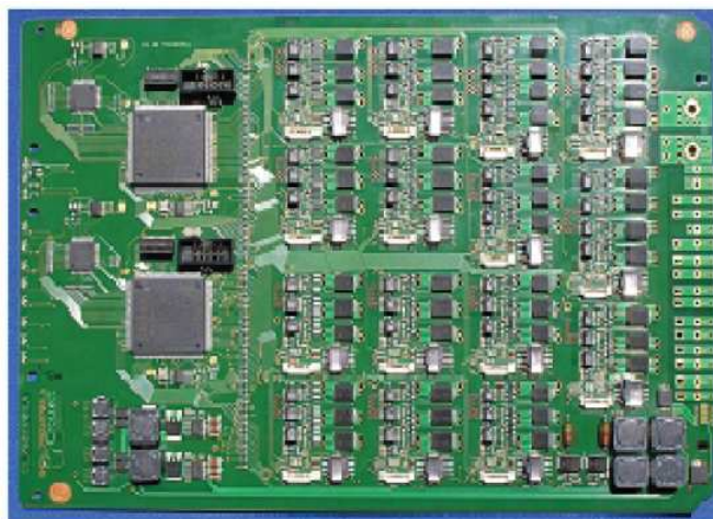
FIGURE 1.9 – Solid State Power Controller (SSPC) utilisé sur un bus 28Vdc
