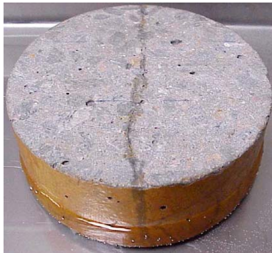
Photographie 6-2 : Apparition très nette de la fissure principale d'un disque de BHP en imbibition
