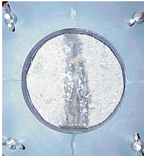
Photographie 7-2 : Percolation de l'eau à travers un disque de béton fissuré au cours d'un essai
