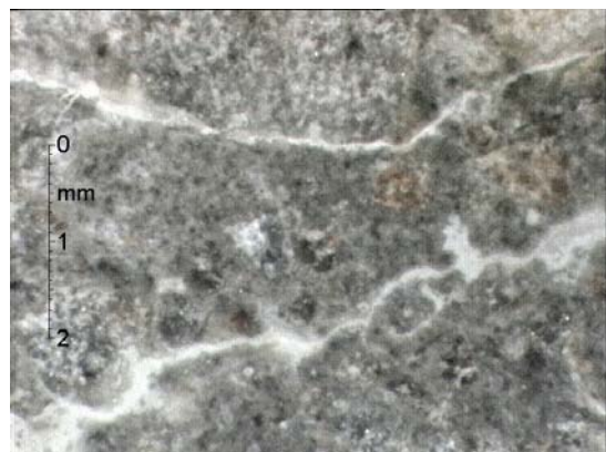
Photographie 6-4 : Observation du dépôt de calcite dans les fissures principales a) et secondaire b) des disques imbibés durant deux mois
