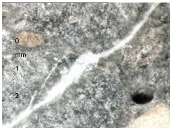
Photographie 6-4 : Observation du dépôt de calcite dans les fissures principales a) et secondaire b) des disques imbibés durant deux mois
