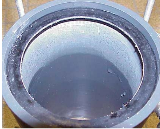
Photographie 8-3 : Dépôt de calcite observé sur la pièce du montage en contact avec l'eau à proximité de l'éprouvette
