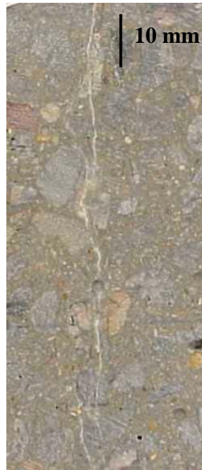
Photographie 6-3 : Apparition d'un dépôt blanchâtre persistant après séchage le long des fissures des disques imbibés durant deux mois
