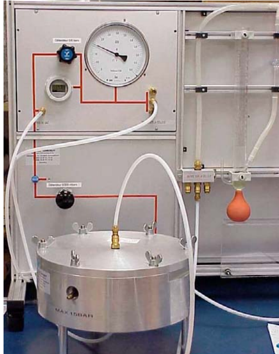
Photographie 2-1 : Vue du dispositif d'injection avec les deux détendeurs et le manomètre digital de 100 hPa de précision ajouté en complément du manomètre d'origine
