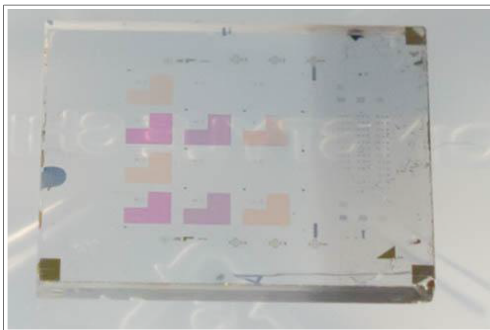
Fig. 2.1.49 – Photographie de l’échantillon à 45^\circ en lumière naturelle montrant la transparence globale des réseaux.
