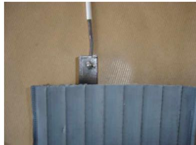
**Photo 18.** Soudure de la connectique sur l'électrode centrale.
