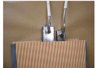
**Photo 19.** Soudure de la connectique sur les électrodes externes.
