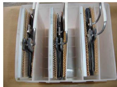
**Photo 21.** 3 cellules dans un bac de batterie.
