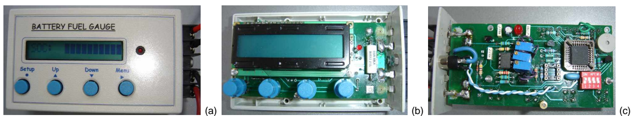
Photos 4. Photos du second prototype : vue de dessus (a) ; intérieur face avant (b) ; intérieur face arrière (c).
