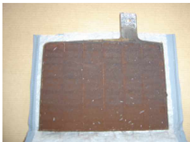
Photo 14. Electrode positive et séparateur.
