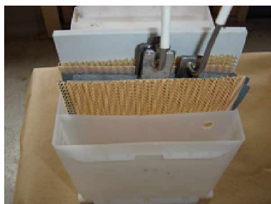
Photo 20. Assemblage final d'une cellule.
