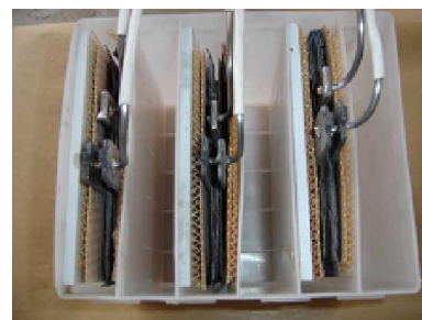
Photo 21. 3 cellules dans un bac de batterie.
