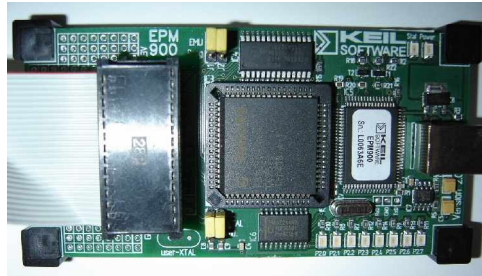
Photo 6. Emulateur utilisé pour développer et graver le programme de la jauge.
