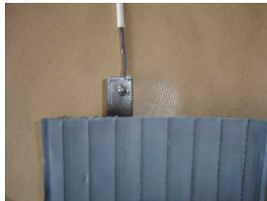
Photo 18. Soudure de la connectique sur l'électrode centrale.
