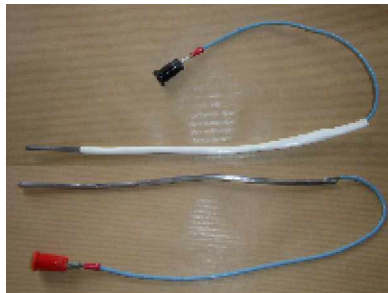
Photo 17. Connectique: allonge de Pb + fil électrique + cosse faston + embase femelle.
