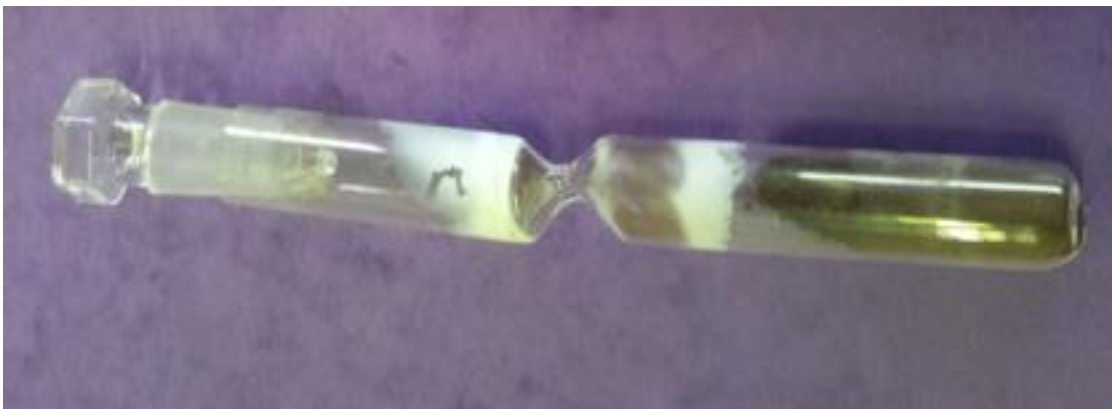
Figure II.2: Photo d'une préparation dans un tube de silice avant les étapes de pompage et de rinçage.
