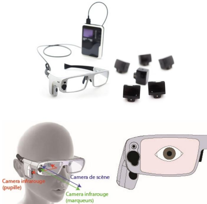
Figure 31. Oculomètre portatif Tobii Glasses, son boîtier d'acquisition et les marqueurs infrarouges (d'après Tobii Glasses Eye Tracker User Manual)
