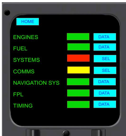
Figure 83. Représentation de la proposition de présentation de l'état des systèmes.
