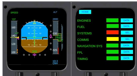
Figure 80. Entrée dans le mode Etat Systèmes, une fois la trajectoire sécurisée (PFD simplifié et ND en page Etat Systèmes agrégés). Réalisation MANAGE..
