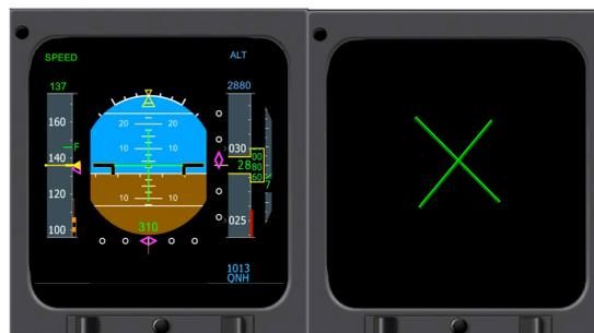
Figure 78. Entrée dans le mode pilotage en priorité lors de la survenue de l'incident critique (PFD simplifié et ND neutralisé). Réalisation de FLY.
