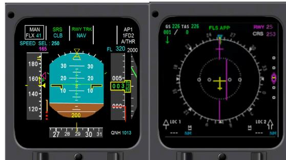
Figure 97. Retour en mode standard, sortie après résolution de l'évènement (PFD et ND classiques)
