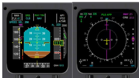
Figure 82. Retour en mode standard, sortie après résolution de l'évènement (PFD et ND classiques)..
