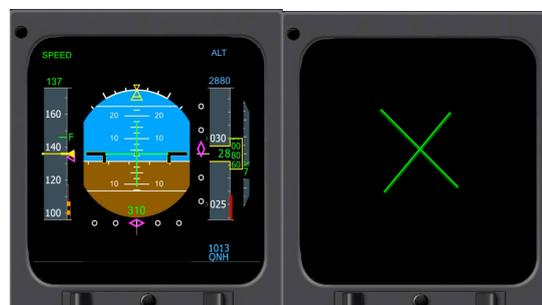
Figure 90. Entrée dans le mode pilotage en priorité (PFD simplifié et ND neutralisé)..
