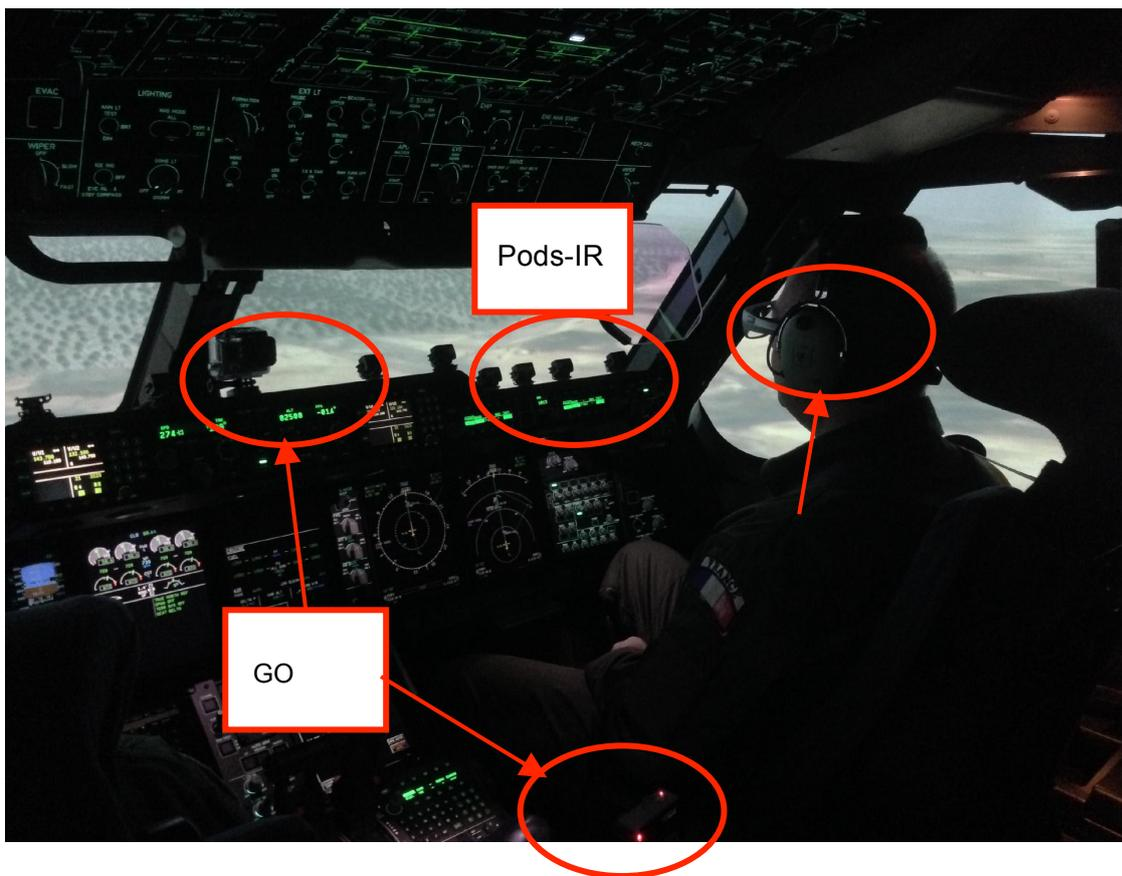
Figure 60. Représentation du dispositif expérimental dans le cockpit du simulateur A400M. Positionnement des 2 GOPROs, eye-tracker, capteurs Pod-IR
