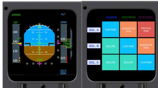
Figure 93. Entrée en mode Choix des solutions (PFD simplifié et ND en matrice de risque).
