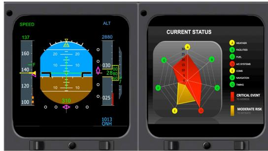
Figure 92. Entrée en mode Projection des contraintes sur la mission (PFD simplifié et ND en page Point de Situation).
