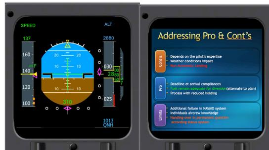
Figure 94. Entrée en mode avantages et inconvénients de la solution (PFD simplifié et ND en page avantages / inconvénients)..
