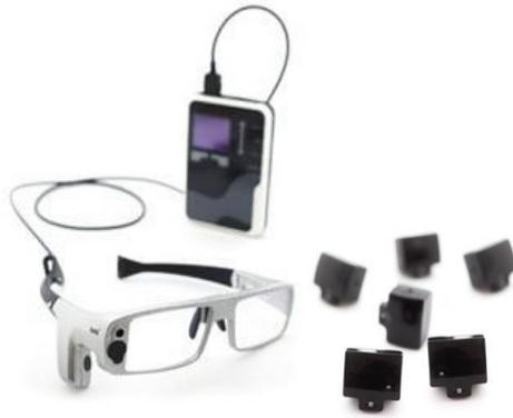
Figure 59. Dispositif de Eye Tracker, les pods (a), les lunettes (b) et l'enregistreur (c)
