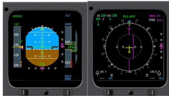
Figure 79. Entrée dans le mode navigation, une fois le pilotage assuré (PFD simplifié et échelle ND adaptée à la temporalité). Réalisation de NAVIGATE.
