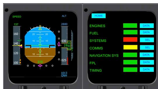
Figure 91. Entrée en mode Etat Systèmes (PFD simplifié et ND en page Etat Systèmes agrégés).
