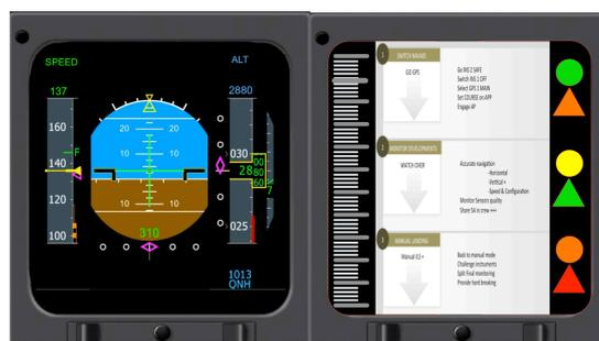
Figure 95. Entrée en mode page application de la solution retenue (PFD simplifié et ND en page Do-List)..
