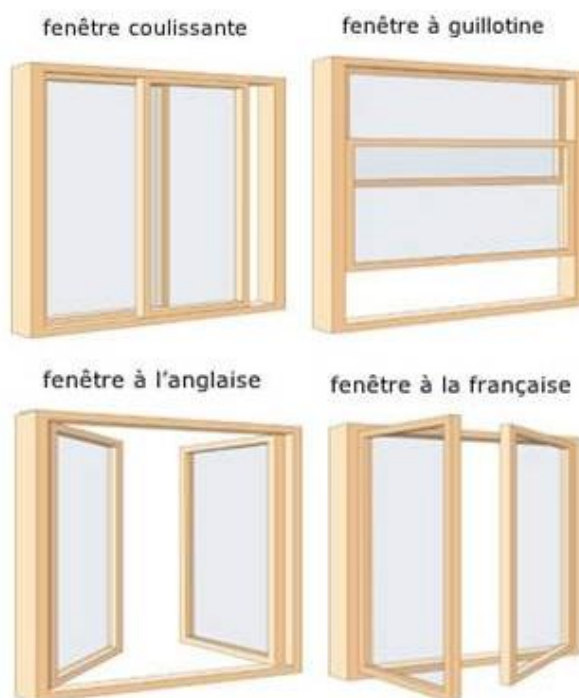
Figure 32 : Fenêtres à coulisse, à guillotine, à l'anglaise et à la française. Source : www.ledictionnairevisuel.com (actif en 2016).
