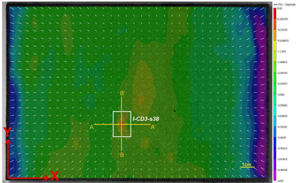
Figure V.1 : Déformation longitudinale \varepsilon_{xx} à t= 87.7h ( w= 28.8\% ) - cas de l'essai CD3-s38.
