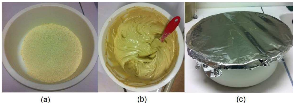
Figure II.2 : Préparation de la boue : (a) poudre déshydratée, (b) boue d'argile et (c) conditionnement.
