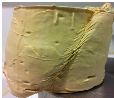
Figure III.5 : Photographie de l'éprouvette d'argile à la fin de l'essai OC-sig200 (OCR = 5).
