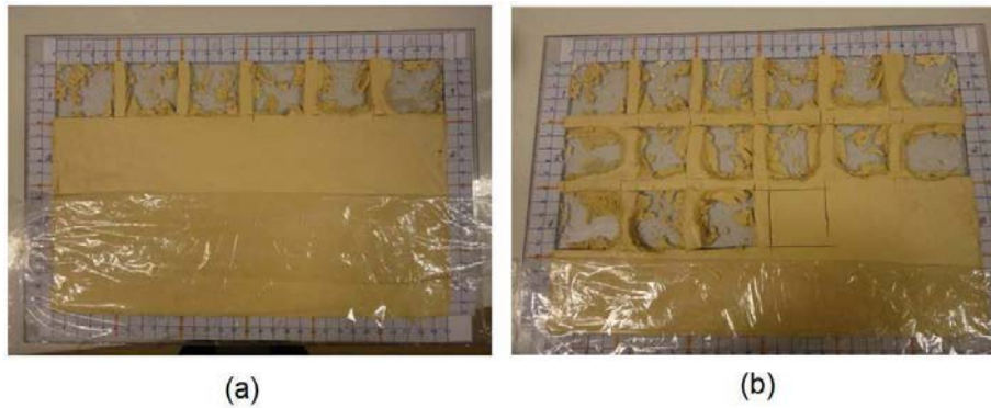
Figure IV.9 : Schéma de découpe des échantillons pour la mesure de la teneur en eau locale sur chemin de séchage libre : (a) première ligne, (b) 3 premières lignes (Wei, 2014).
