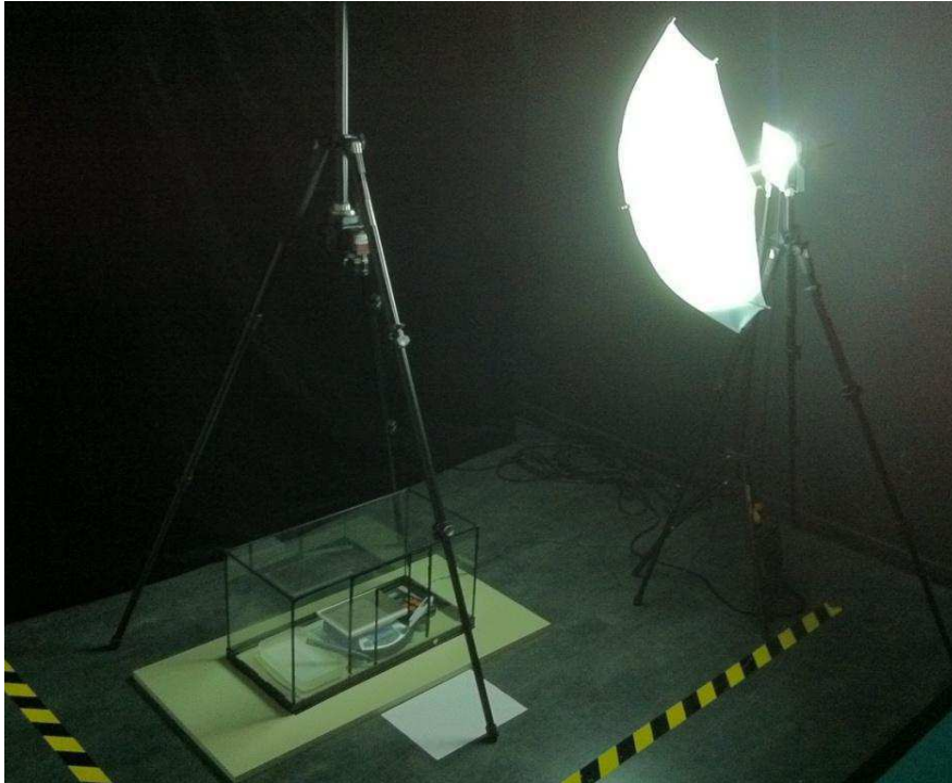
Figure II.48 : Disposition et orientation de l'éclairage sur le système expérimental de la dessiccation.
