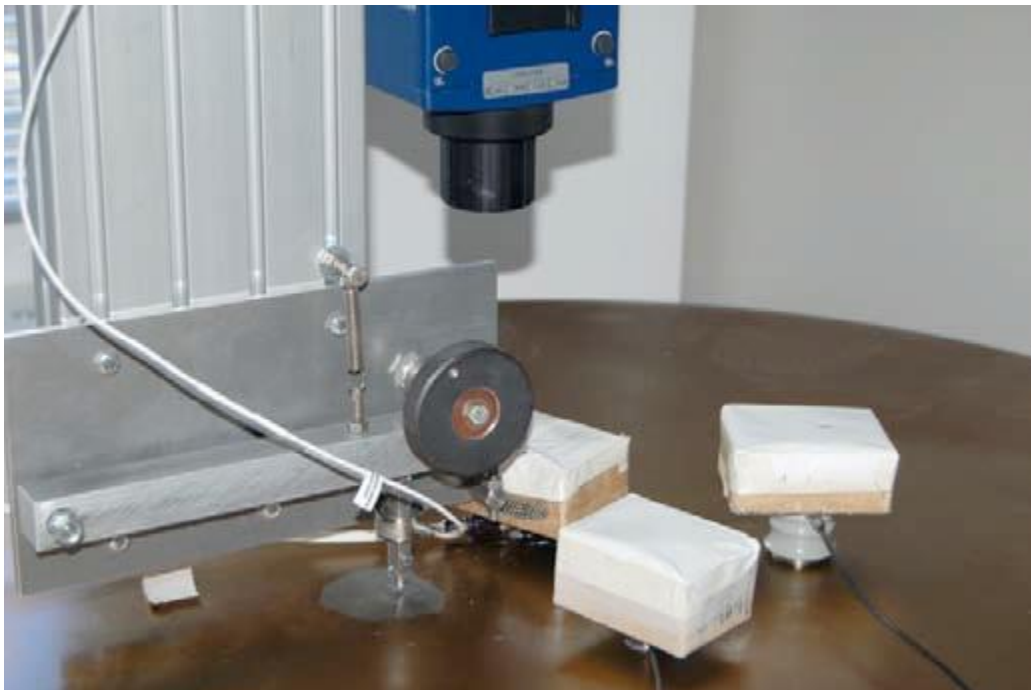
Figure 1. 24 : Dispositif pour la calibration par échelon de force. [15]
