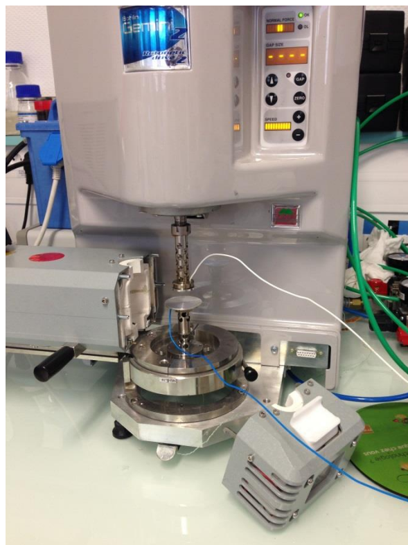
Figure A2-1 : Image du rhéomètre en configuration plan-plan pour une mesure EIS
