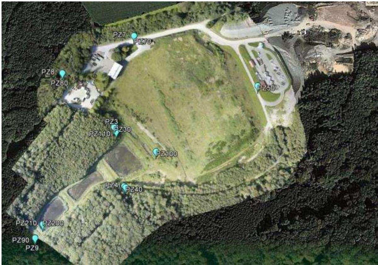
Figure 2.17 : implantation sur image Google Earth et orthophotographie drone des piézomètres.
