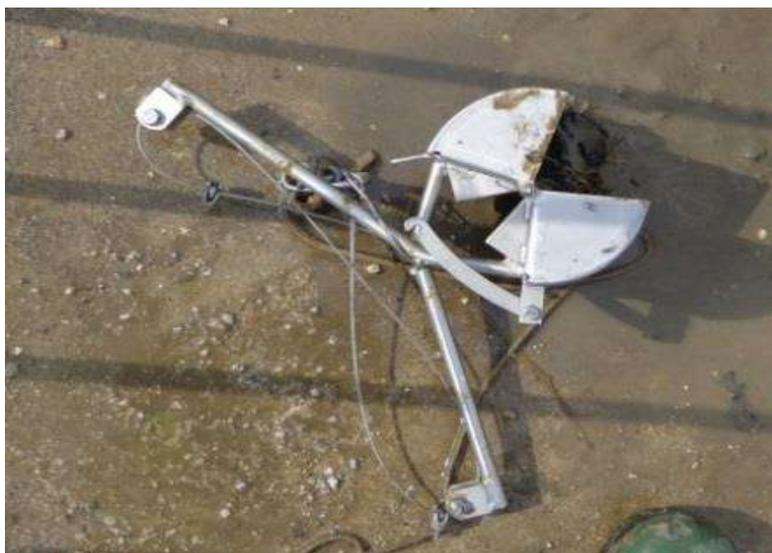
Photo 4.1 : détail de la benne à sédiments Van Veen utilisée sur site.
