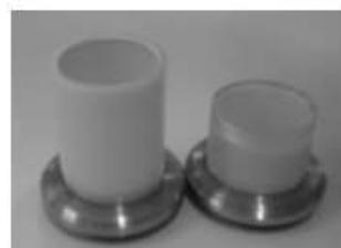
Figure 7.2: deux cuves de sédimentation de 20 et 10 ml
