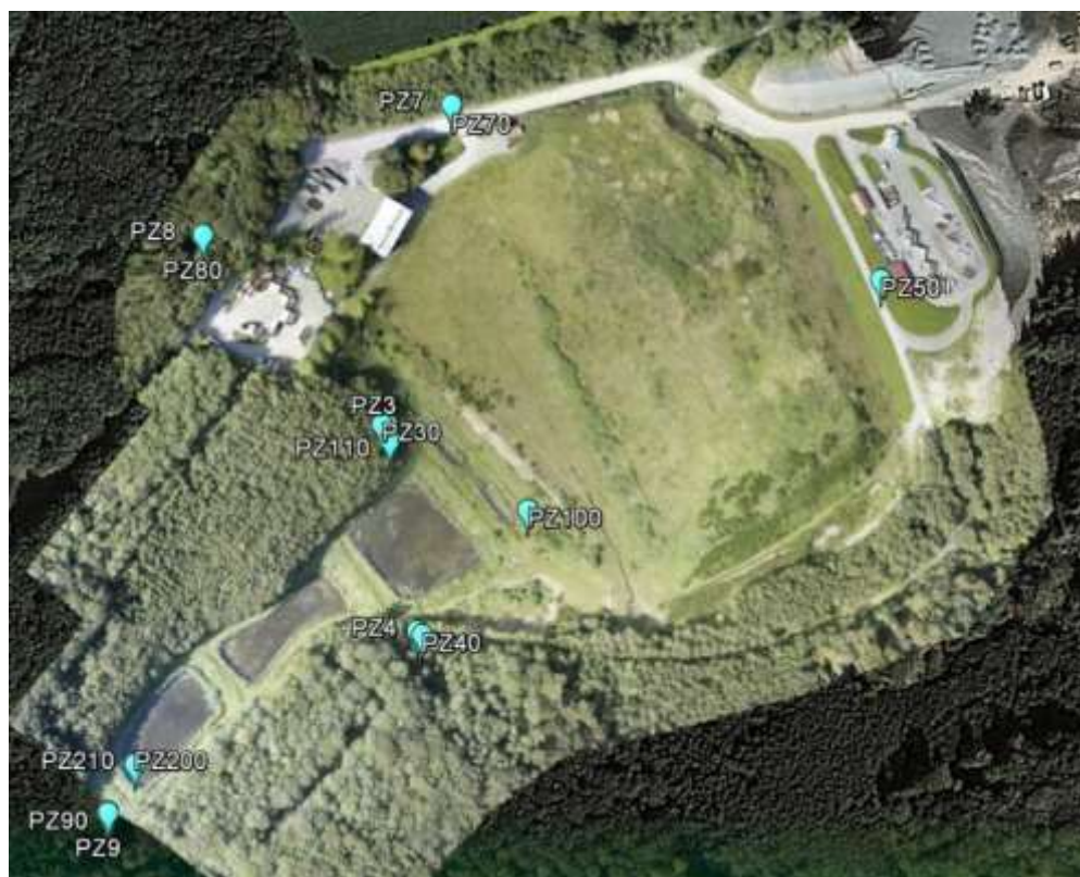
Figure 5.2 : implantation sur image Google Earth et orthophotographie drone des prélèvements d'eau dans les piézomètres.
