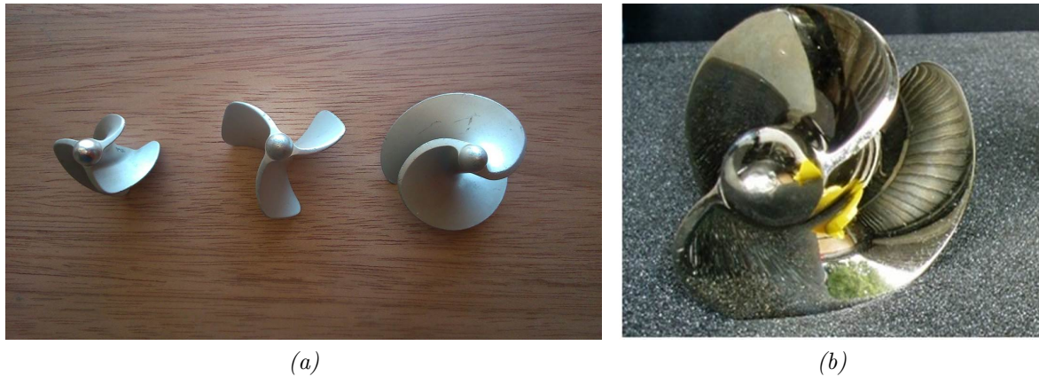
FIGURE 11.3 – (a) Hélices C2 de type 6, 3 et 1 (de gauche à droite) et (b) hélice C31 en bronze. Source Slimani (2014).
