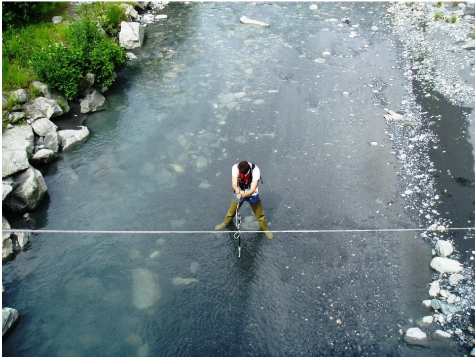
Un jaugeage au moulinet sur le Glandon à St Etienne-de-Cuines (Savoie, France). Photo : A. Hauet.
