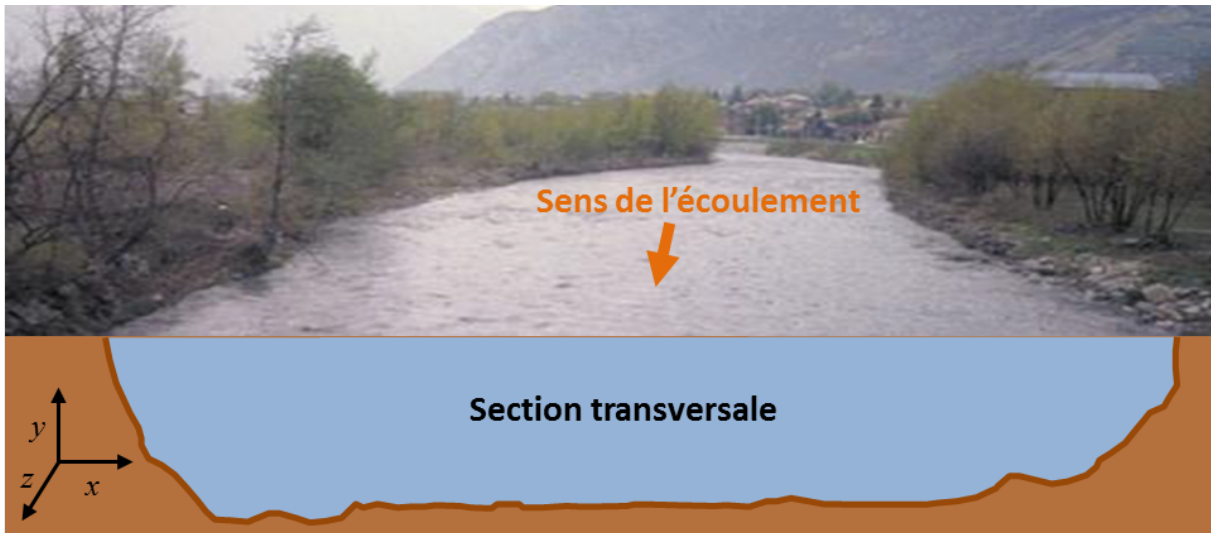
FIGURE 1.1 – Section transversale d’une rivière et définition des axes x , y et z . Schéma adapté de Hauet (2006).
