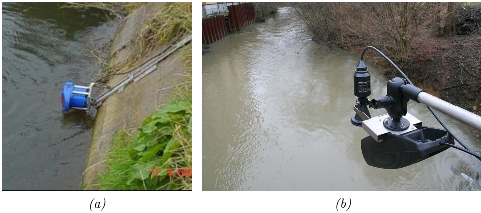
FIGURE 3.11 – (a) Un H-ADCP hors de l'eau fixé sur un rail. (b) Un radar déployé depuis une passerelle. Sources : Hydro International et Flow-Tronic S.A.
