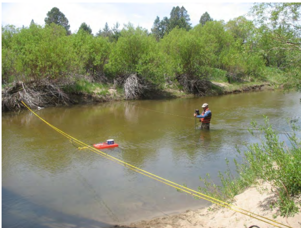
FIGURE 14.5 – Exemple de comparaison entre deux techniques de jaugeage (ADCP et courantomètre). Source : USGS.
