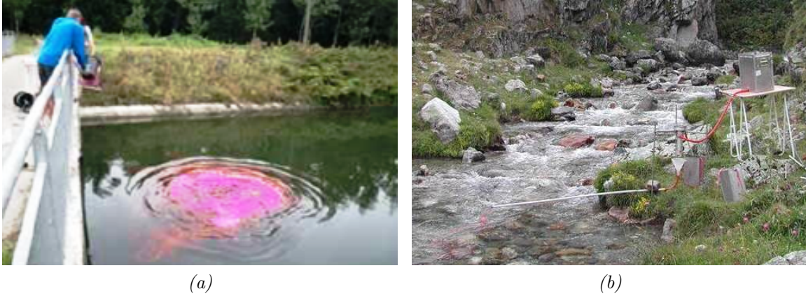
FIGURE 3.2 – Injection (a) instantanée et (b) à débit constant (Rhodamine WT). Source EDF-DTG.
