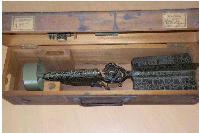
FIGURE 3.3 – Moulinet de Woltman dans sa caisse de transport. Photo A. Despax.
